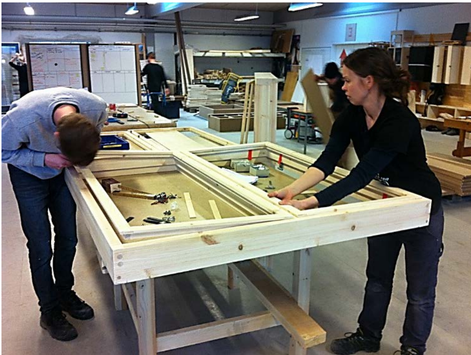
To snedkerlæringe på Københavns Tekniske Skoles snedker-afdeling, er i gang med at lægge sidste hånd på eet af de vinduer, som de studerende på KTR har tegnet til et almennyttigt boligbyggeri, hvor de oprindelige vinduer er væk.
