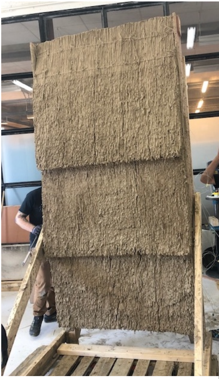
Figur 12. Testemnet sprøjtet med moræneler og med indbyggede lerplader
