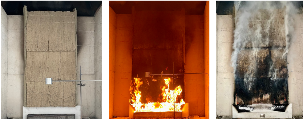
Figur 8. Fuldskala testemne med påsprøjtet ler, der også havde indbygget plader af ler mellem lagene af strå. Før, under brandprøvning og efter 30 min. Foto Anne Beim
