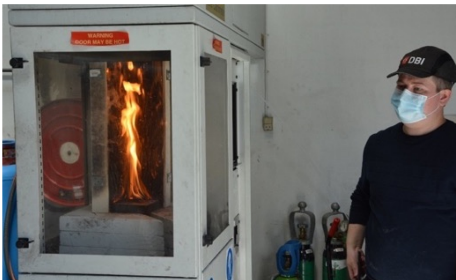
Figur 4. Her ses brændkammeret til Mini-SBI test med Mads Hohmann fra DBI, som stod for at eksekvere brandtestene. Foto: Jørgen Kaarup
