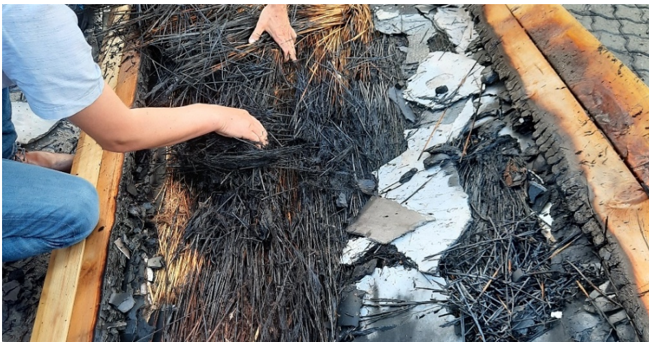
Figur 16. Undersøgelse efter testen, der vises bagsiden af emnet, hvor vi ser at bagbe- klædning har været eksponeret.
