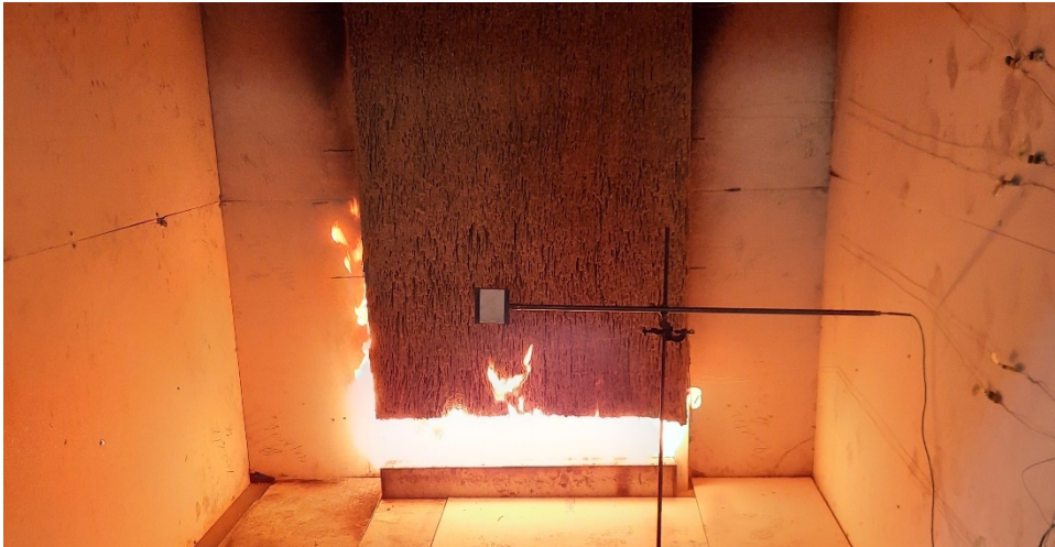
Figur 15. Flammerne antænder bagvedliggende konstruktion
