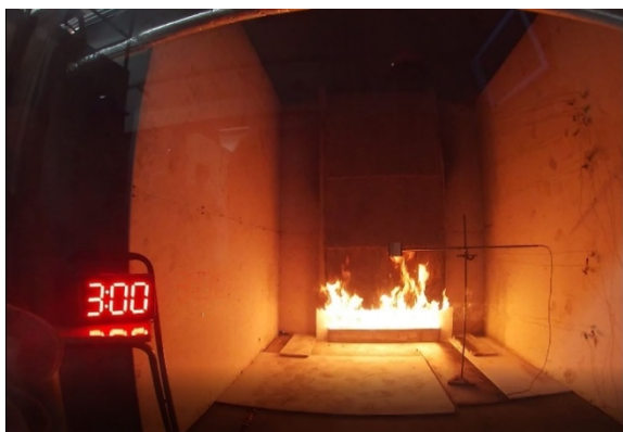
Figur 22. Test 2 – Sprøjtet med ler og indbyggede lerplader efter 3 min
