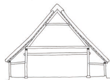
Principsnit i højremkonstruktion.
