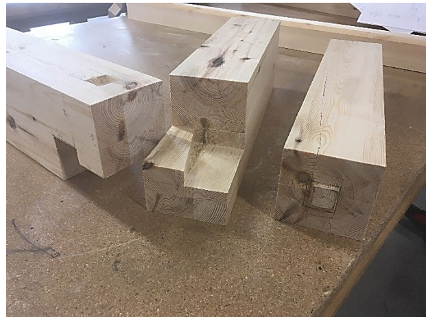
Færøhusets selvlåsende hjørnesamling. Stolpen står dog kun på en ganske lille tap – plus tyngdekraften.
