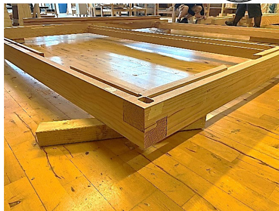
Maskinfræsning af remmenes 'krydskæmning' efter fræseskabeloner. Til højre er hele bundremmen samlet, med de særlige 'låste' hjørnesamlinger med taphul til stolpen og vandrette noter til vægplankerne.
