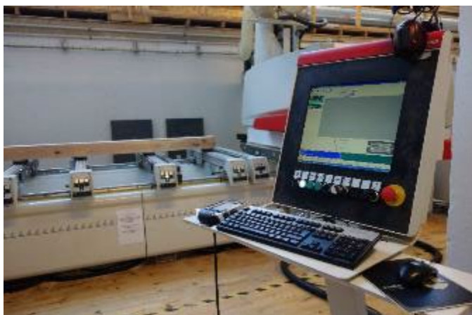
Selve CNC-Fræsemaskinen ses i baggrunden. I forgrunden den computer, der styrer processen på 'skafottet'.
