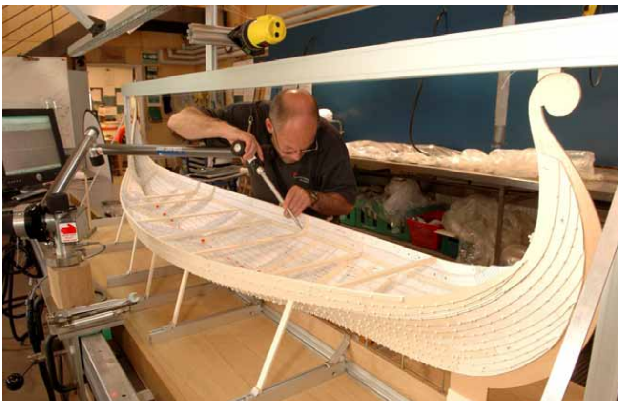
Fig. 4.25. Rekonstruktionsmodellen blev digitalt opmålt med en Faro Arm ® , og modellens dimensioner blev overført direkte til 3D programmet Rhinoceros ® . Foto Werner Karrasch, Vikingskibsmuseet i Roskilde.
