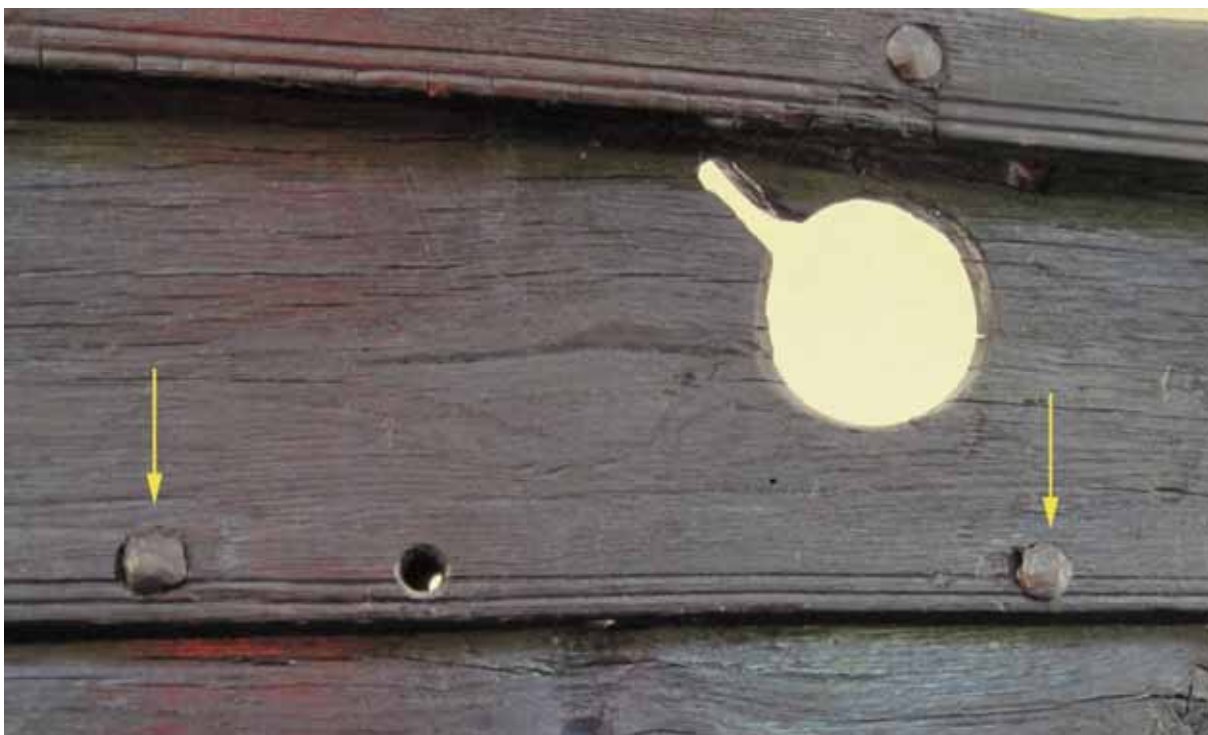
Fig. 6.7. Enkelte steder på skibets udvendige side ser det ud til, at klinknaglen, der fastholder 12. bordgang i dag, er sat gennem et oprindeligt trænaglehul. Foto forfatteren.
