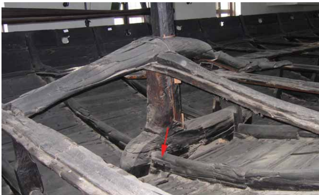
Fig. 6.21. Kølsvin og mastefisk i Osebergskibet. Bemærk de små kileformede træklodser der støtter kølsvinet sideværts. Foto Thomas Finderup.
