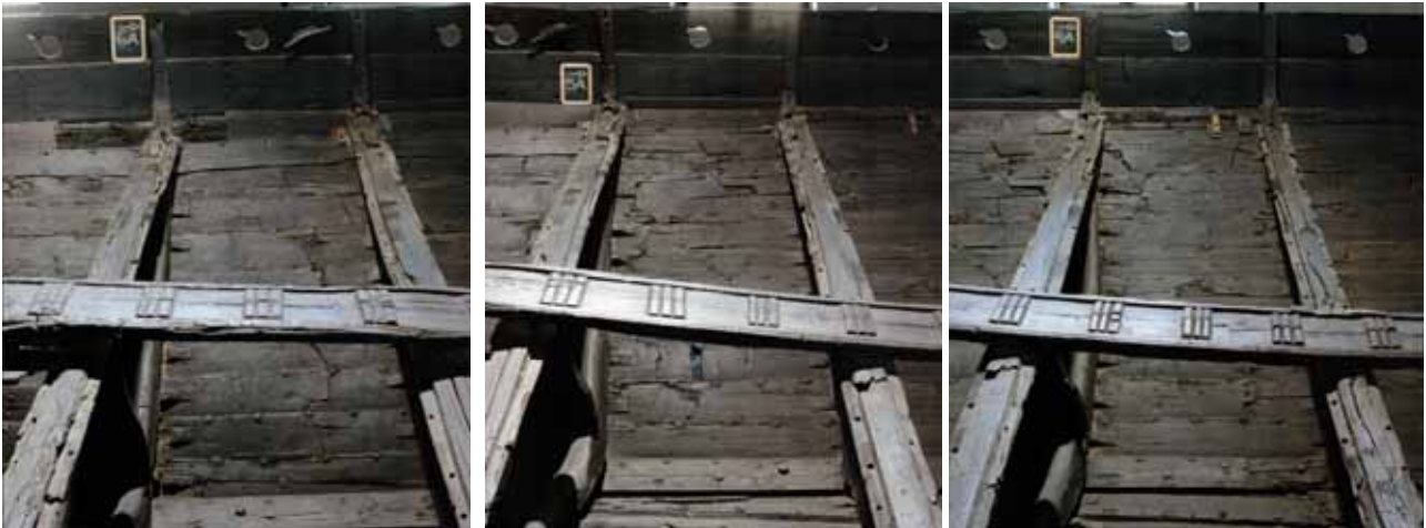
Fig. 6.28. På fotos af skibet uden dørk, kan det konstateres, at det må være bite 4A, der skal vendes, så rummet mellem 4A og 5A er det rum, hvor dørken lå løst. Foto Kulturhistorisk Museum i Oslo.
