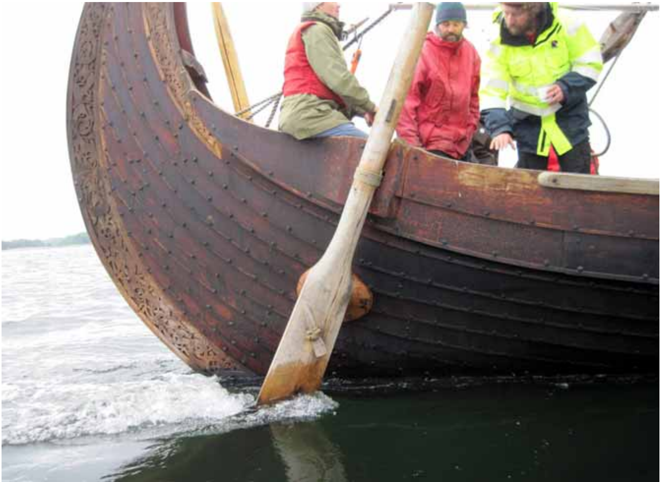
Fig. 10.19. Det større ror, der blev fremstillet for at styre Saga Oseberg bedre, gjorde stor modstand i vandet og forstyrrede den samlede balance mellem skrog, sejl og ror. Foto forfatteren.
