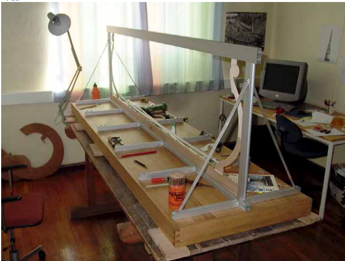
Fig. 4.12. Byggerammen danner et stabilt grundlag for rekonstruktionsmodellen.
