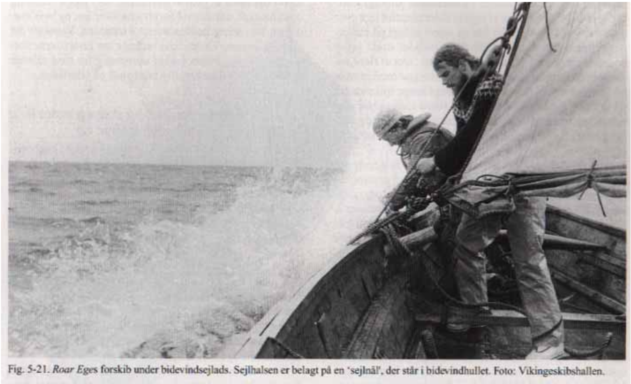
Fig. 8.4. Halsen på fuldskalarekonstruktionen af Skuldelev 3, Roar Ege, blev fastgjort til en sejlstikke, som også anvendes i nyere tids råsejlstradition. Foto Vikingeskibsmuseet i Roskilde.
