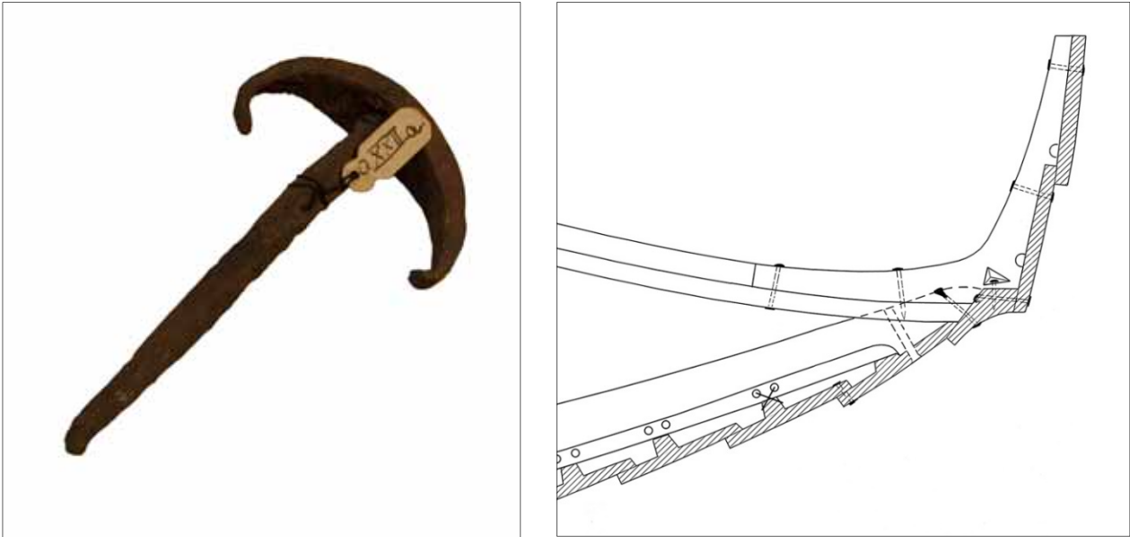
Fig. 6.9. Bundstokkene var oprindelig surret til 4,0 cm høje klamper indtil 9. bordgang, hvor topenderne var fastgjort med en trænage og en jernnagle med rombeformet klinkplade. Foto Kulturhistorisk Museum i Oslo. Tegning forfatteren. Ikke i skala.
