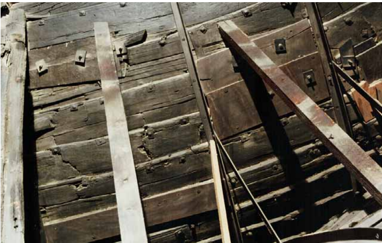
Fig. 4.1. På trods af at Osebergskibets yderside fremstår helstøbt og ensartet, viser skibets inderside, at det ikke har været enkelt at samle de mange fragmenterede skibsdele til et sammenhængende skibsskrog.
