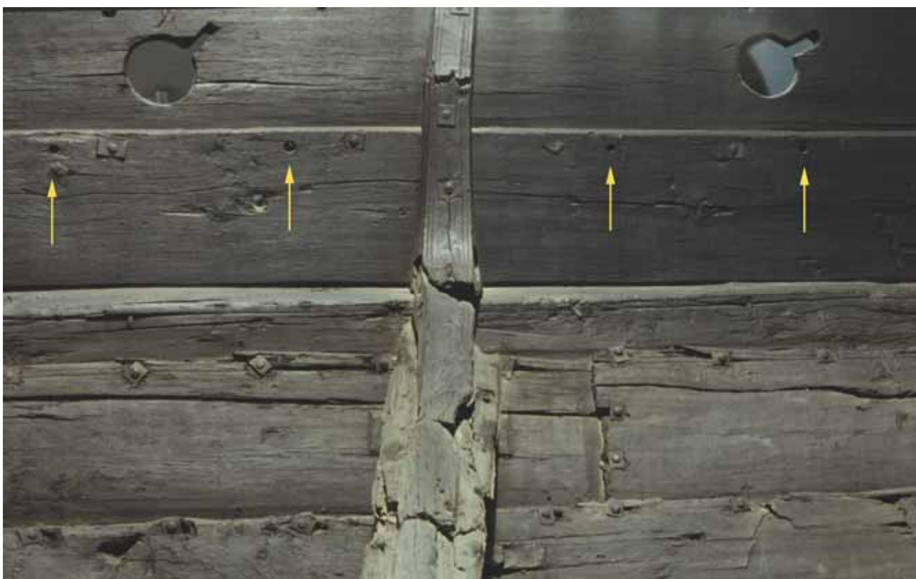
Fig. 6.6. Den øverste bordgang var oprindeligt fastholdt med 12,0 mm tykke trænagler. Det er uvist, om der samtidig var klinknagler, eller om de er sat i senere. Foto Kulturhistorisk Museum i Oslo, illustration forfatteren.
