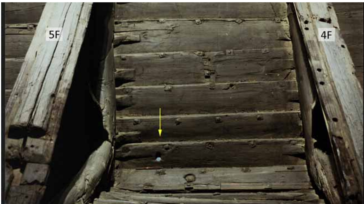
Fig. 6.29. I rummet mellem spant 4F og 5F er der boret et hul, så vandet kunne løbe ud når skibet var trukket på land for vinteren. Hullet har været lukket med en kort træprop, bundproppen. Foto Kulturhistorisk Museum i Oslo, illustration forfatteren.
