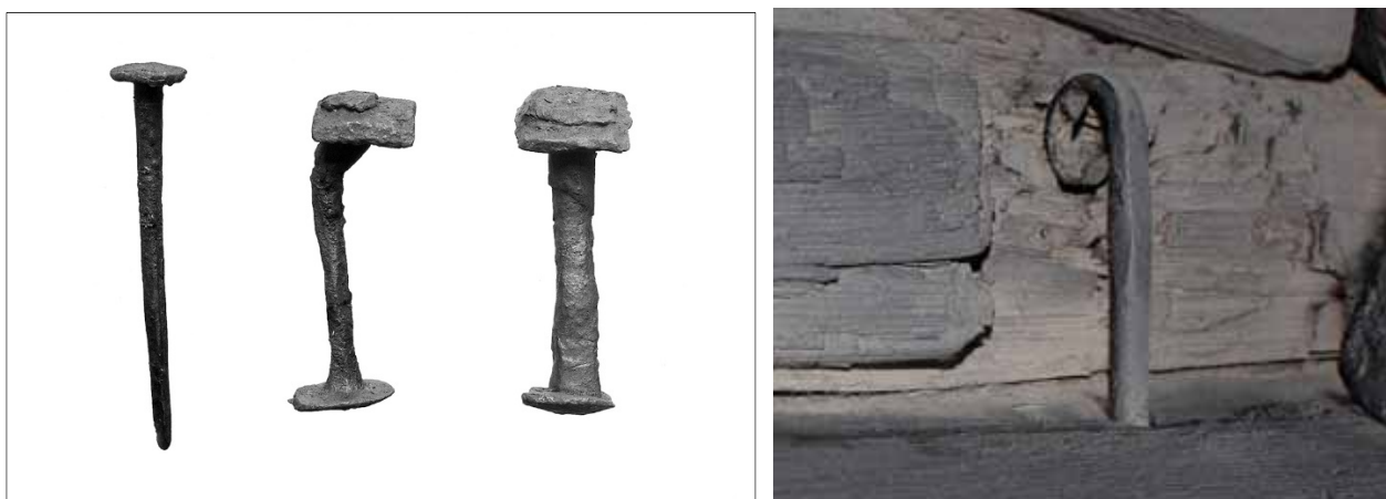
Fig. 6.5. Et spiger og to klinknagler tv. og et vejnet spiger th. Midt på kølen er anvendt klinknagler, og ved spundingen i køl og stævne er anvendt spiger. Alle bord er samlet med klinknagler med undtagelse af 11. bordgang, der blev fastgjort til meginhufren med lange vejnede jernspigre. Foto tv. Kulturhistorisk Museum i Oslo. Foto th. forfatteren.
