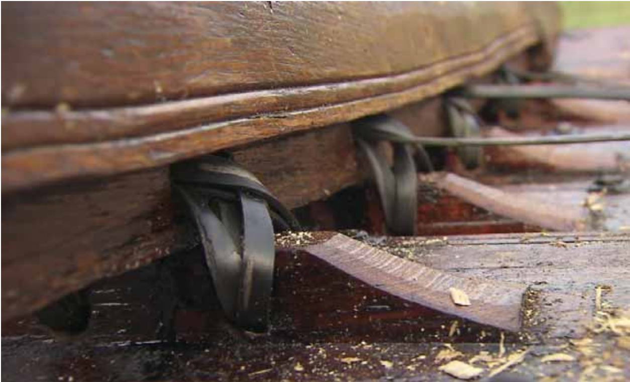
Fig. 6.17. Bundstokkene var oprindeligt surret til bundstokkene med strimler af hvalbard, som her på Saga Oseberg. Foto forfatteren.
