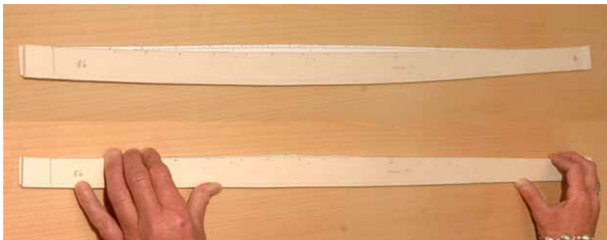
Fig. 4.21. Modelbordenes form blev ændret langskibs i 11. og 12. bordgang, så de passede til undervandsskrogets rekonstruerede skrogform. Deres formændring blev kontrolleret ved en sammenligning med skabelonerne af bordene fra det udstillede skib. Foto Werner Karrasch, Vikingeskibsmuseet i Roskilde.
