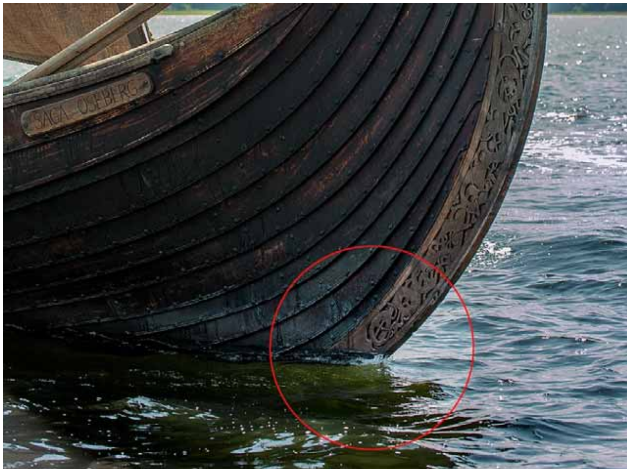
Fig. 10.23. Udskæringerne begynder lige over vandlinjen både for og agter, når Saga Oseberg er i afbalanceret trim. Foto Werner Karrasch, Vikingskibsmuseet i Roskilde. Illustration forfatteren.
