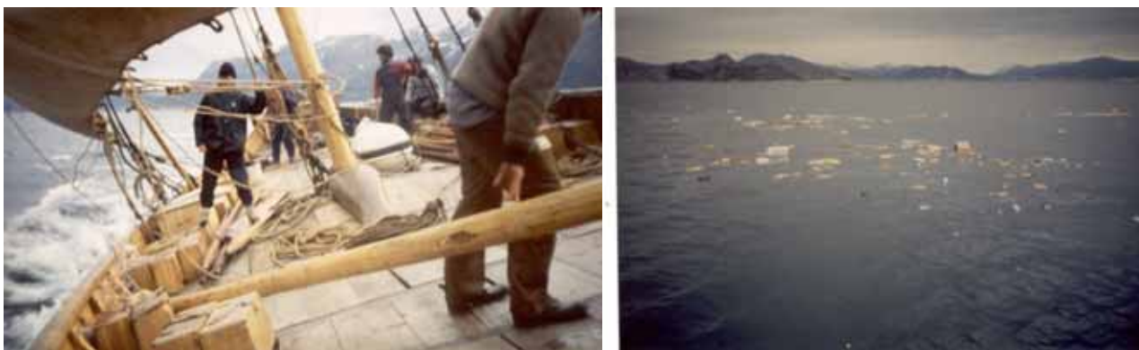
Fig. 3.10. Dronningen forliser 6. maj 1988 ved Sunnmøre i Norge. Ved 10 knobs fart og 10° krængning gik bovbølgen over rælingen, og skibet sejlede sig selv ned på 20 sekunder. Foto H. Borgfjord.
