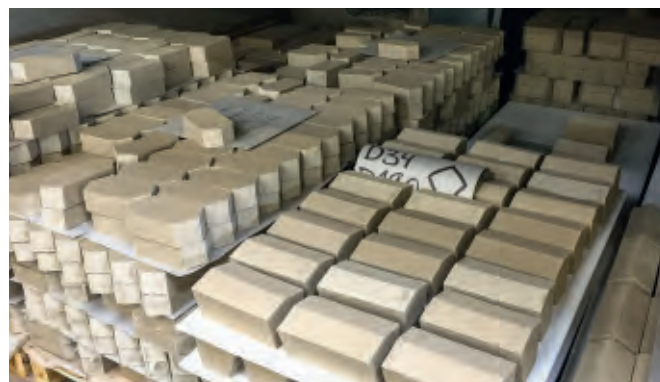
Die Architekten entwickelten in Zusammenarbeit mit Petersen Tegl die 13 verschiedenen Formsteine für die gewünschten Mauern.
