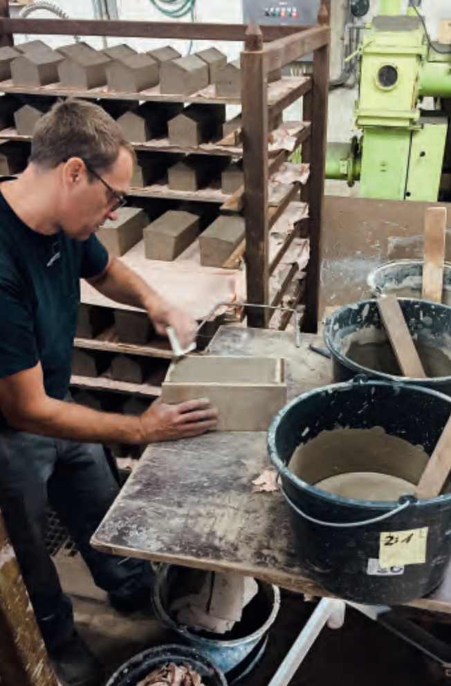
Etwa die Hälfte der Produktion von Petersen Tegl, auch die Formsteine für das Museum De Lakenhal, werden in der Ziegelei in Broager von Hand geformt – nach mehrere hundert Jahre alten Verfahren.
