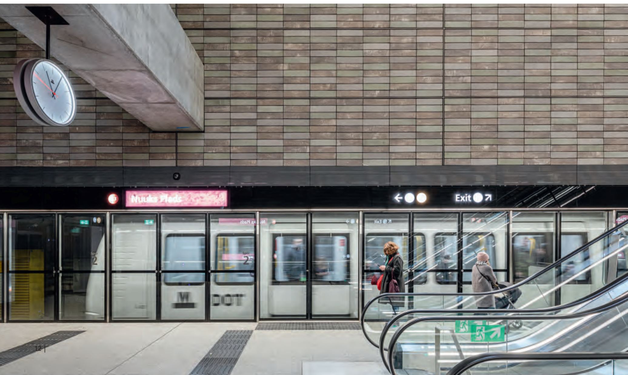
Eine gläserne Wand trennt Gleise und Bahnsteige. Ein Zugang zu den Schienen ist nicht möglich. Wenn ein Zug hält, öffnen sich die Türen des Zuges und die der gläsernen Wand gleichzeitig.
