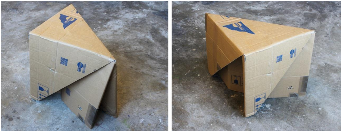
Bastard nr. 1, model 1:1, 40 x 40 x 37 cm, foldet af 2-lags 3 mm bølgepap, kan bære ca. 100 kg.
