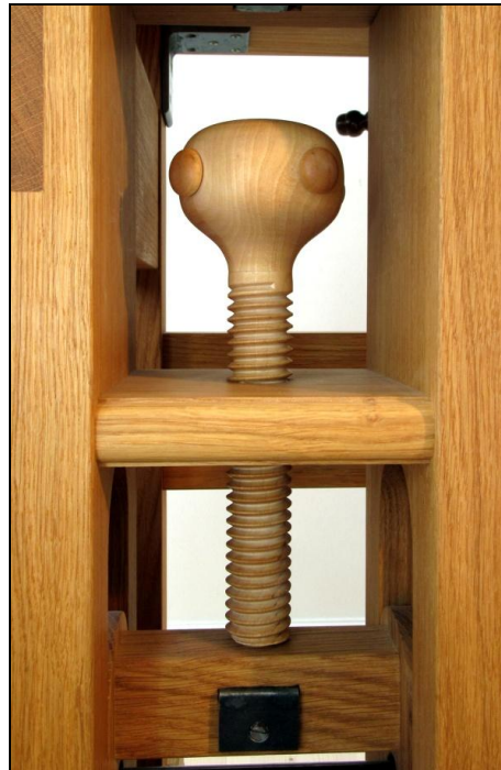
Fig. 49: Træskruer i birk til højdejustering af drivelementet Foto: Erckrath
