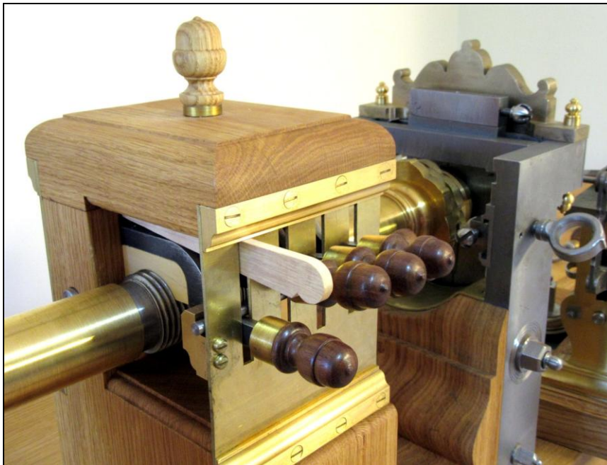
Fig. 99: Detalje gevindboks med fire gevindstørrelser
