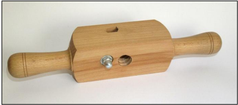
Fig. 116: Gevindskær (ny), gevindstørrelse passende til spindelhoved, traditionel udformning
