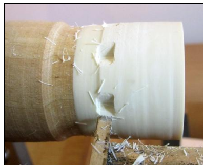
Fig. 74: Rosetdrejningen som skrabeteknik, trin II Foto: Erckrath
