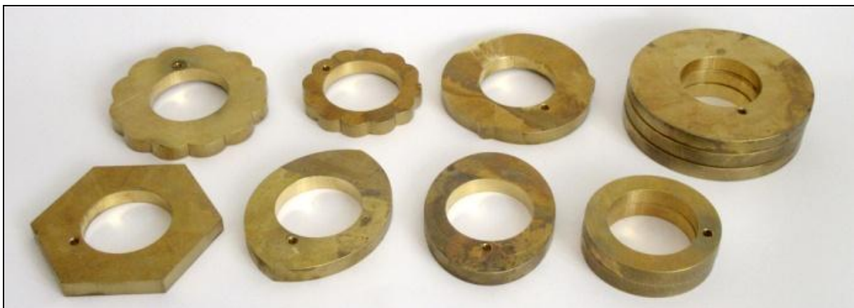
Fig. 118: Forskelligt udformede rosetter og ekstra udstyr som afstandsringer og "blanco"-rosetter Foto: Erckrath
