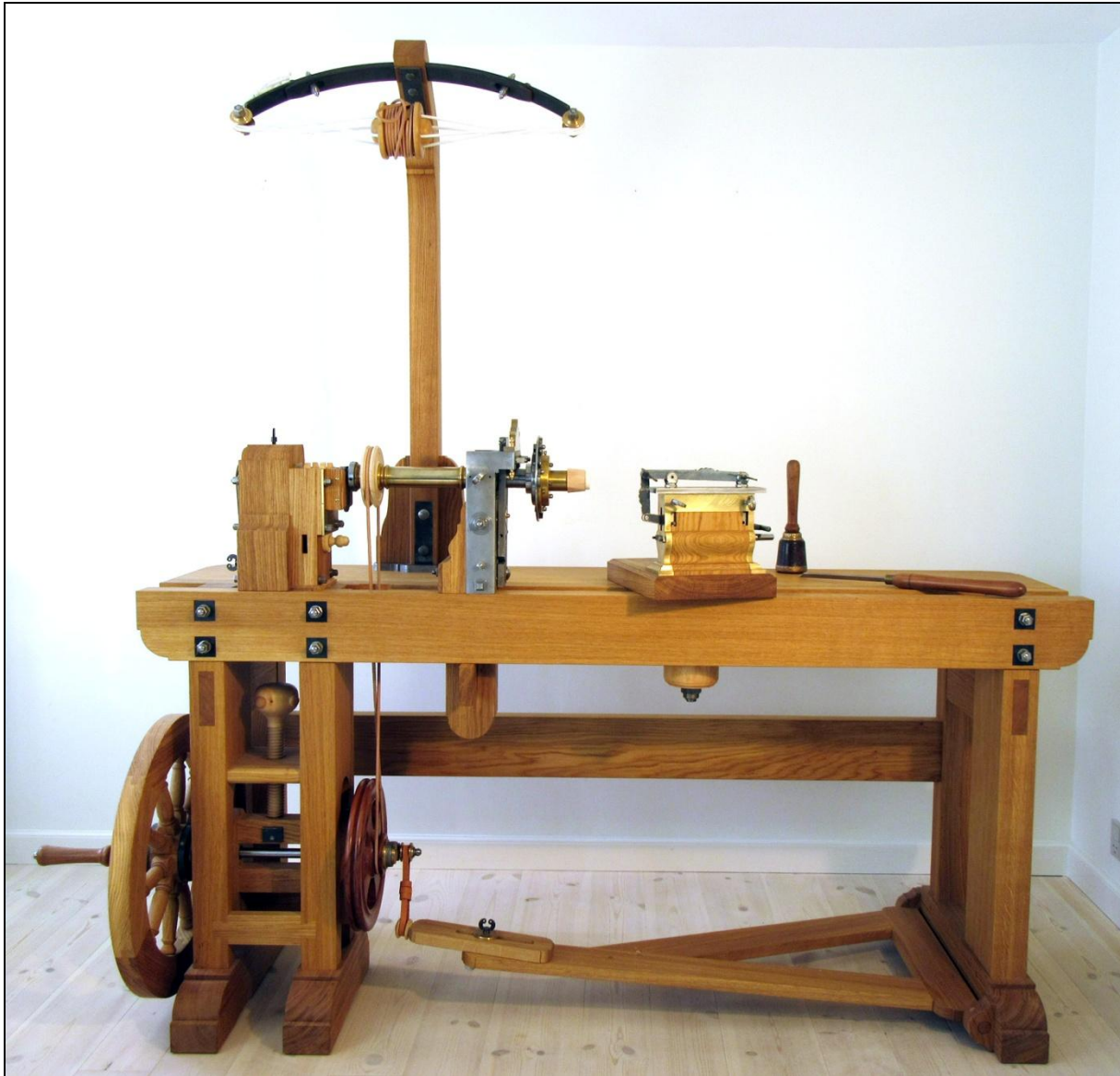
Fig. 106: Rekonstrueret ornamentdrejbænk med opsætning til ovaldrejning (detaljer se fig. 107-110) Foto: Erckrath
