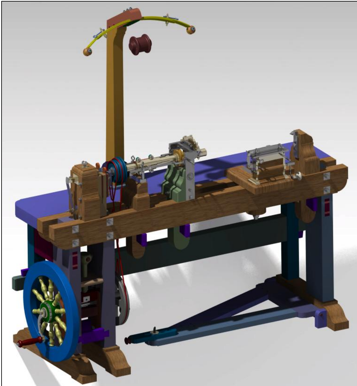
Fig. 2: Færdig tegning, 3D-model af ornamentdrejbænken, udført i CATIA, Illustration: Bengtsson & Erckrath
