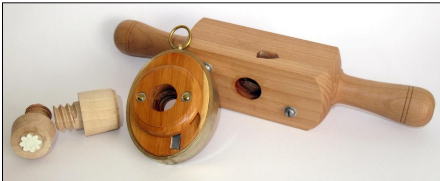
Fig. 117: Gevindskær til gevindskæring af patronens tap Foto: Erckrath
