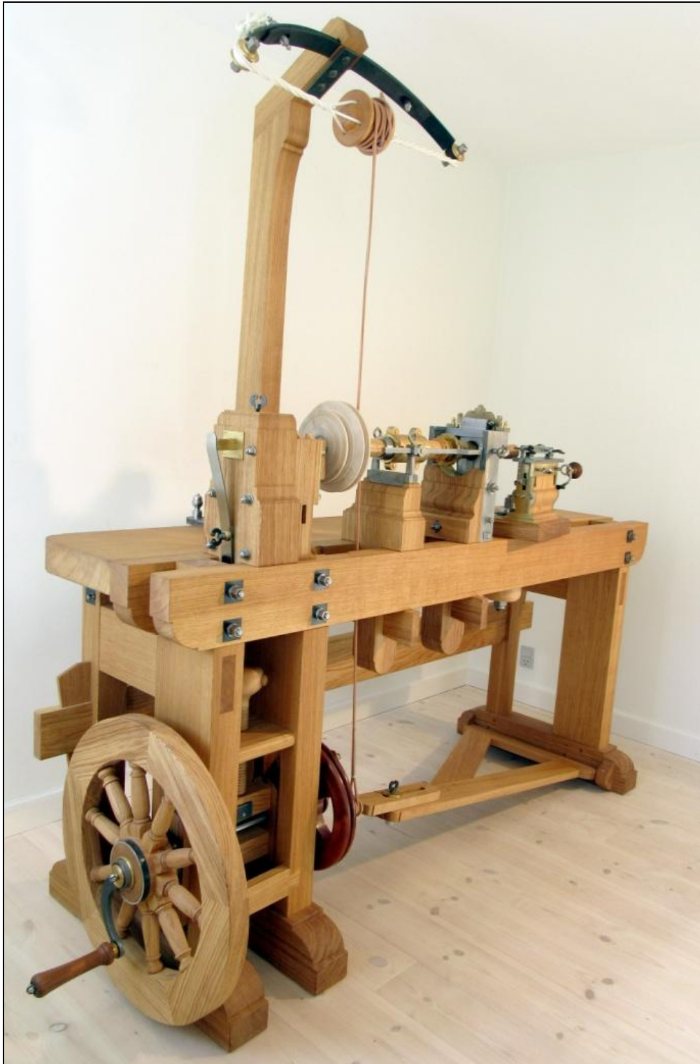
Fig. 81: Rekonstrueret ornamentdrejbænk med opsætning til spiraldrejning (detaljer se fig. 82-90) Foto: Erckrath
