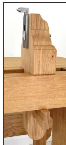
Fig. 58: Pinoldok med højdejusterbar pinol, kileanordning til fiksering mellem drejbænkens vanger
