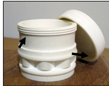
Fig. 104: Udvendig og indvendig skåret gevind (se piler) Foto: Erckrath
