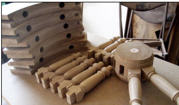
Fig. 36: Præcisionsarbejde, detalje af svinghjulet Foto: Erckrath Svinghjulets enkelte dele blev tilpasset inden limningen.
