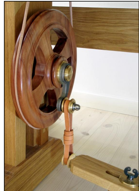
Fig. 45: Drivhjul til kontinuerligt drev udført som trappeskive med to repositioner, udført i pære Foto: Erckrath
