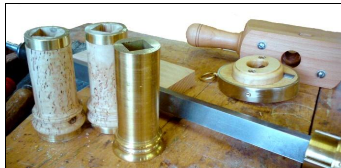
Fig. 42: Detaljer (spindelaksel med spindelementer) og specielt fremstillet værktøj (gevindskær)
