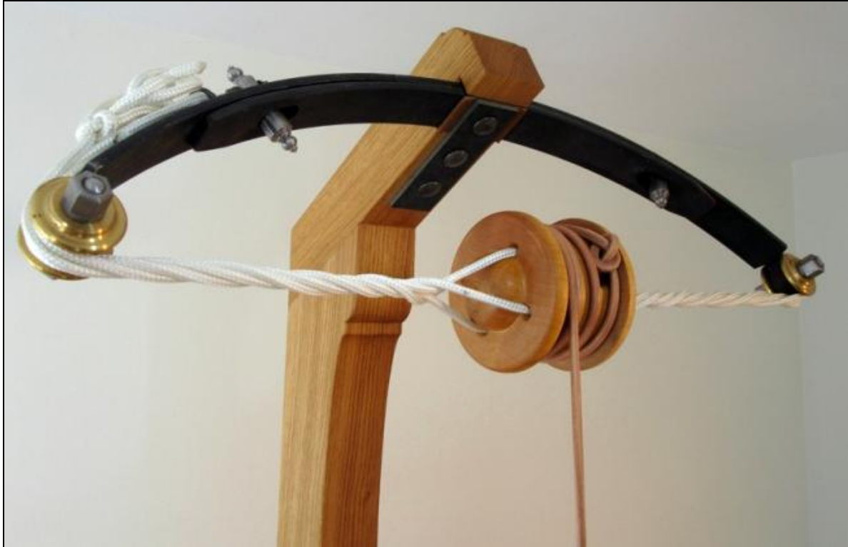
Fig. 53: Fjederen i hærdet stål, monteret på fjederholderen
