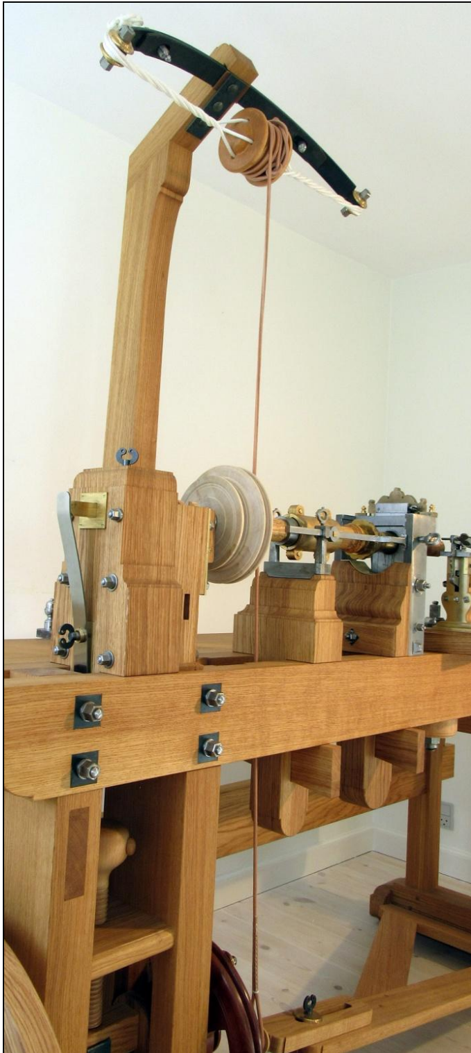
Fig. 50: Drivanordning til intermitterende drev med remmen ført fra fjederen rundt om spindelen til pedalen Foto: Erckrath
