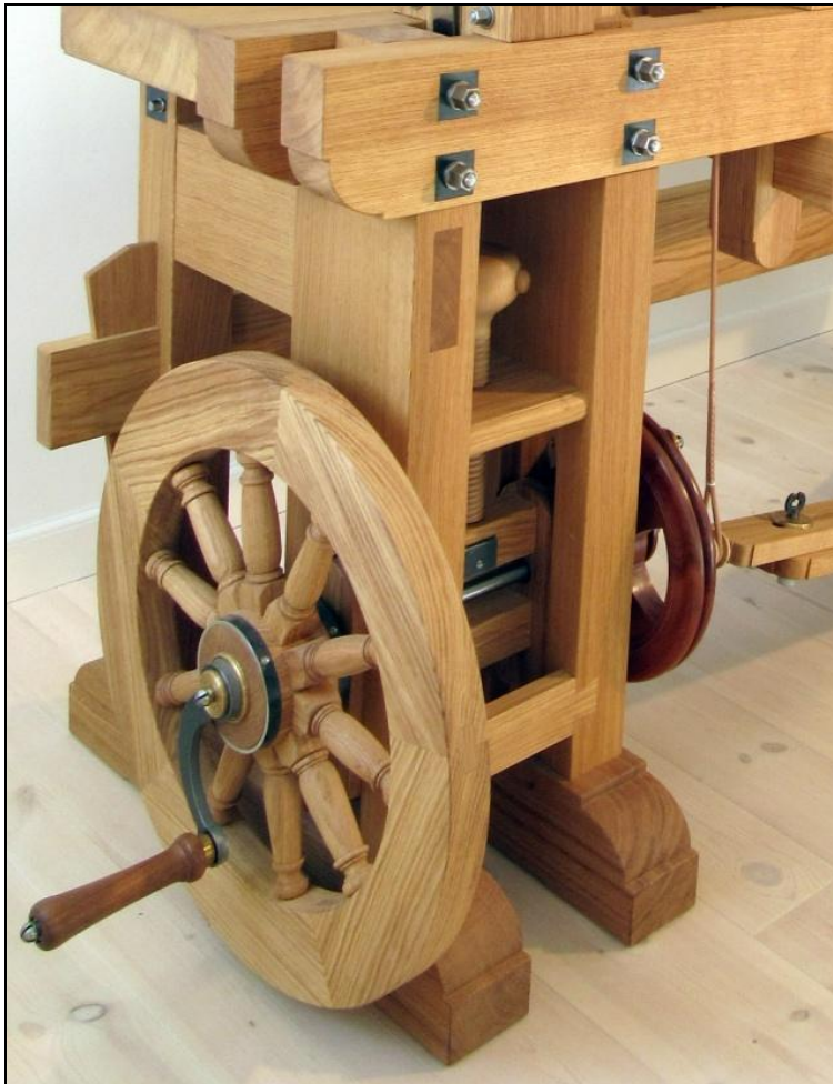
Fig. 44: Drivsystem til kontinuerligt drev med svinghjul i eg Foto: Erckrath
