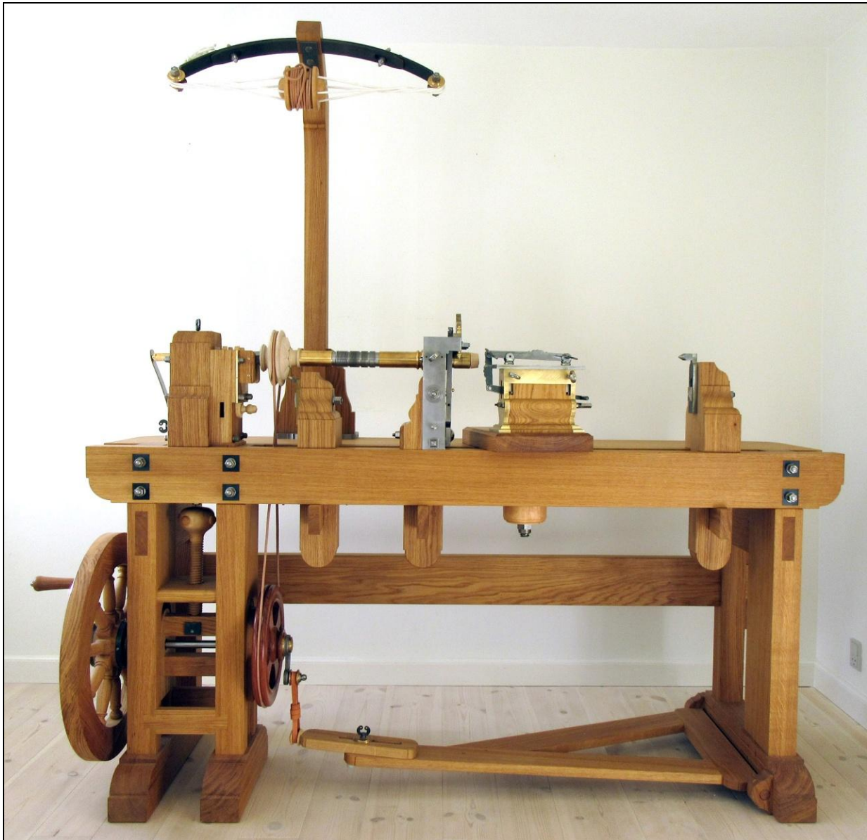
Fig. 43: Rekonstrueret drejebænk Foto: Erckrath
