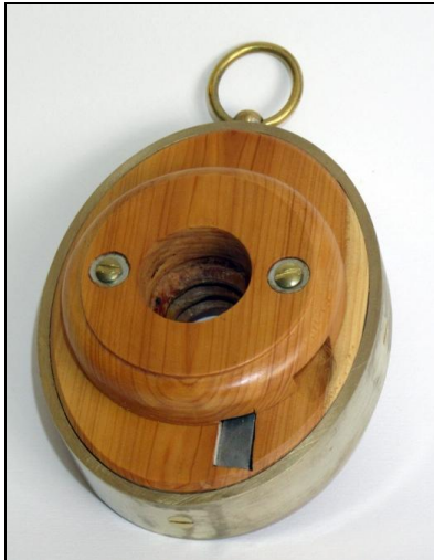
Fig. 115: Genskabt gevindskær, gevindstørrelse passende til spindelhoved Foto: Erckrath
