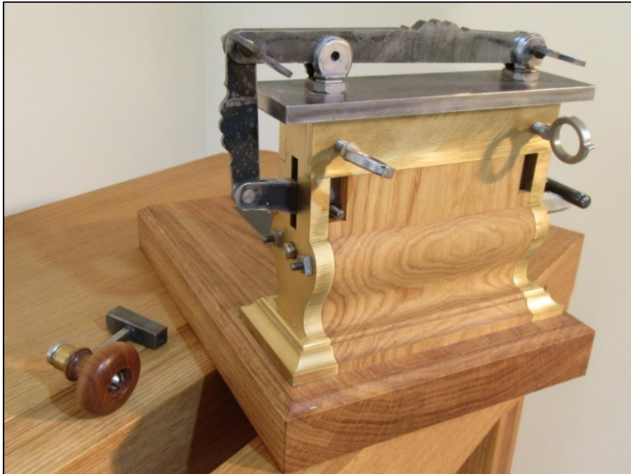
Fig. 62: Anlæg til fikseringsmekanisme til ornamentdrejning
