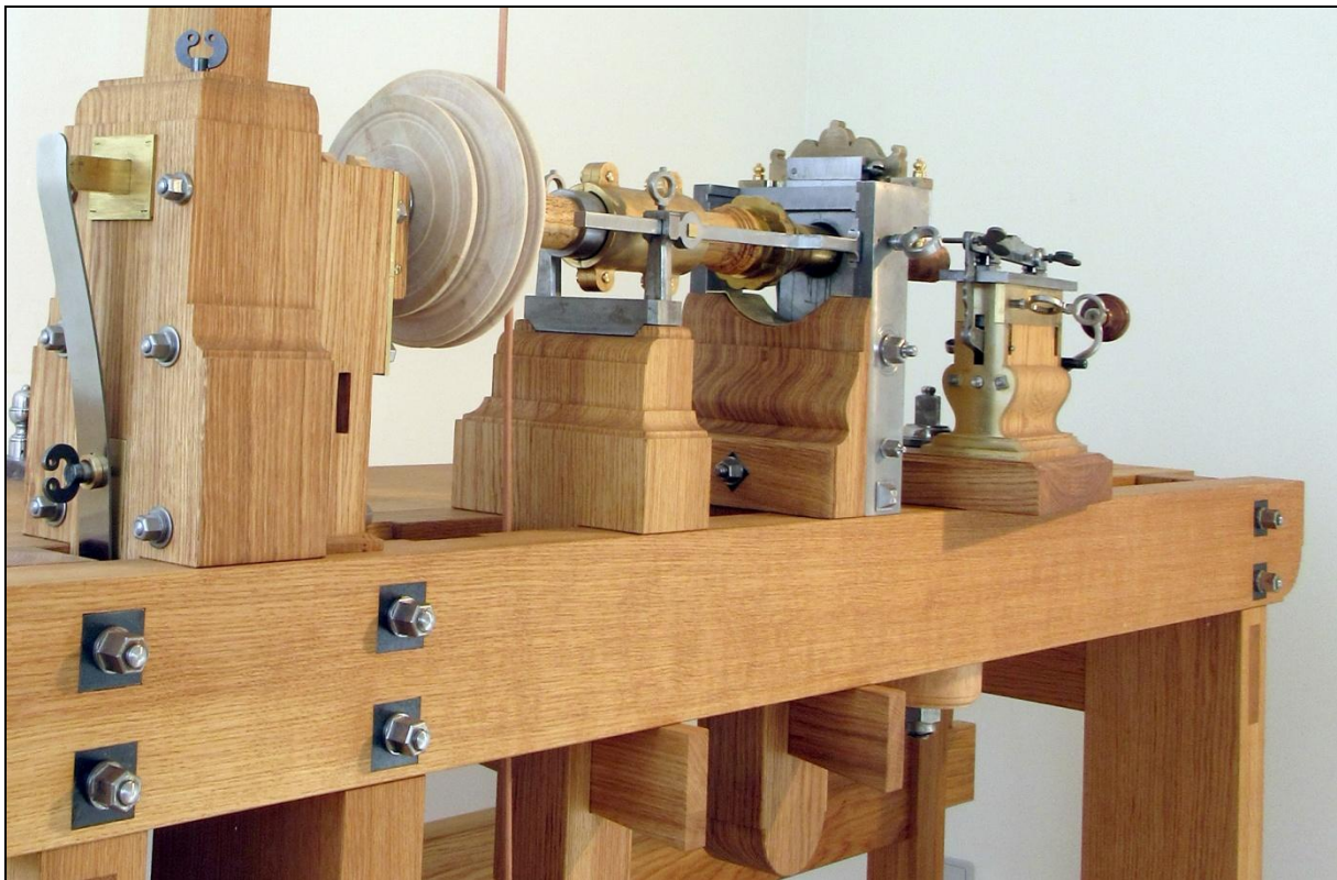
Fig. 83: Drejbænken opsat med spiralanordningen og anlæg Foto: Erckrath
