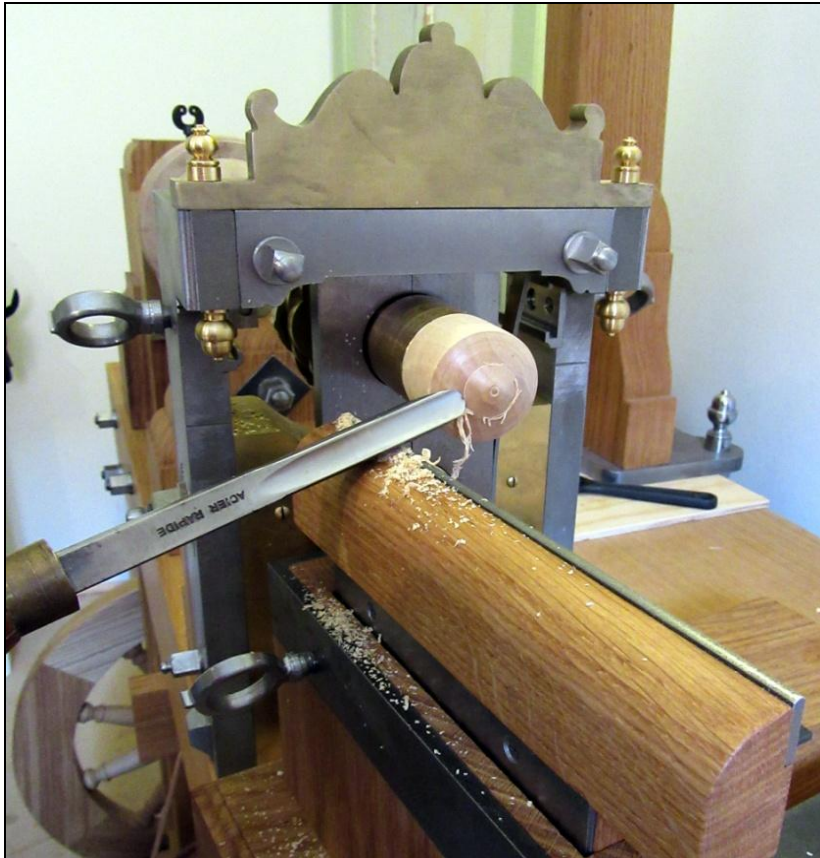
Fig. 59: Frihåndsdrejning med "frit opsat" drejeemne Foto: Erckrath
