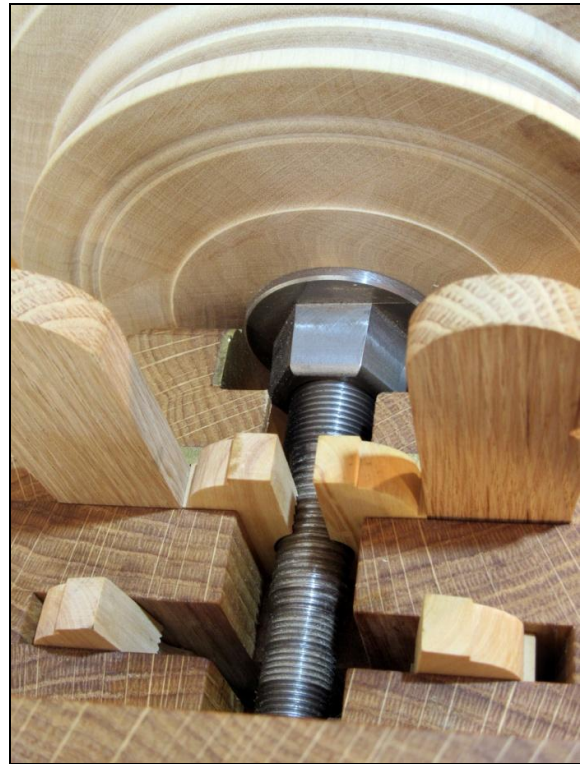
Fig. 101: Gevindskærteknik med den bagerste spindeldoks saksformede aftaster (buksbom) Foto: Erckrath
