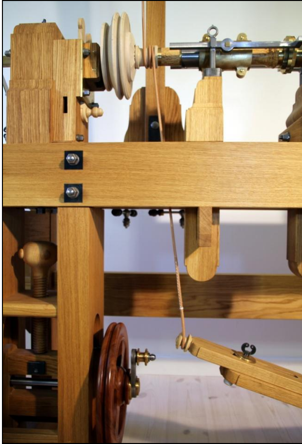
Fig. 84: Spiraldrejningen udføres med fjederdrev, kontinuerligt drev er frakoblet Foto: Erckrath
