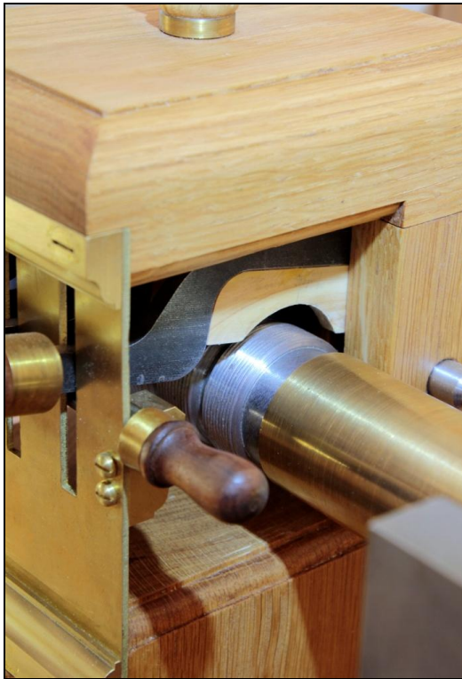
Fig. 100: Gevindboks med løftet aftaster og fritgående spindel Foto: Erckrath
