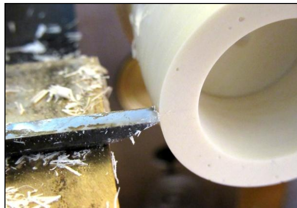
Fig. 61: Genstanden centreret og rettes til inden videre bearbejdning Foto: Erckrath
