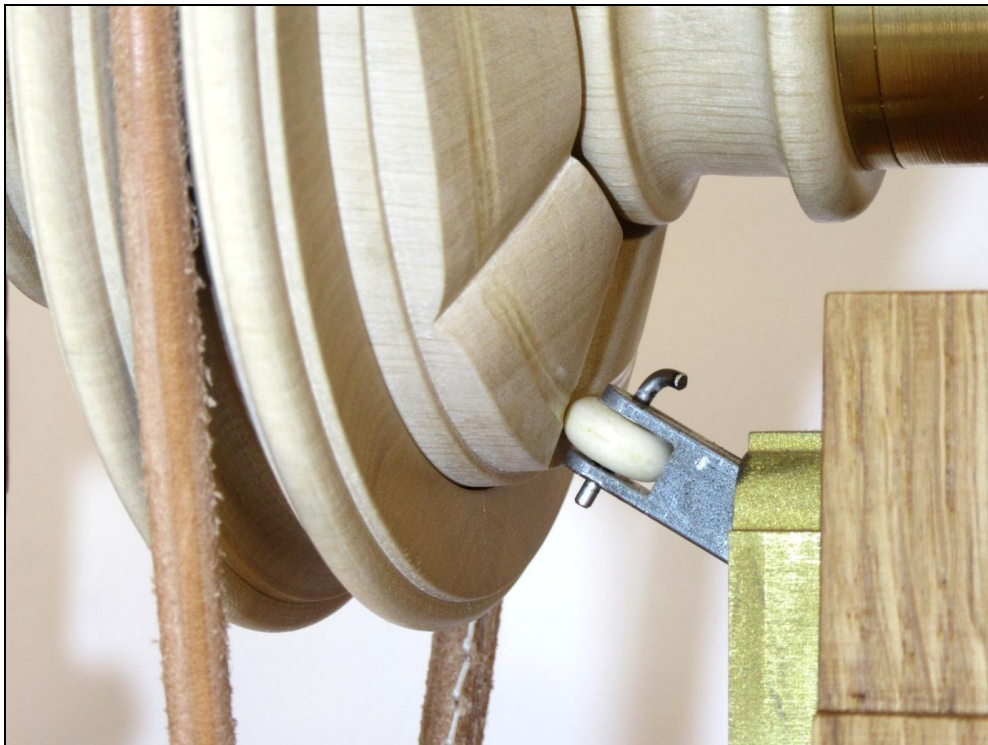
Fig. 94: Aftasteren udformet som benhjul, tydelige slitagespor efter anvendelse Foto: Erckrath
