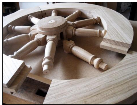
Fig. 37: Præcisionsarbejde, detalje af svinghjulet Foto: Erckrath Svinghjulet blev samlet hvorefter hjulet blev justeret i forhold til centret for at sikre en jævn rotation.
