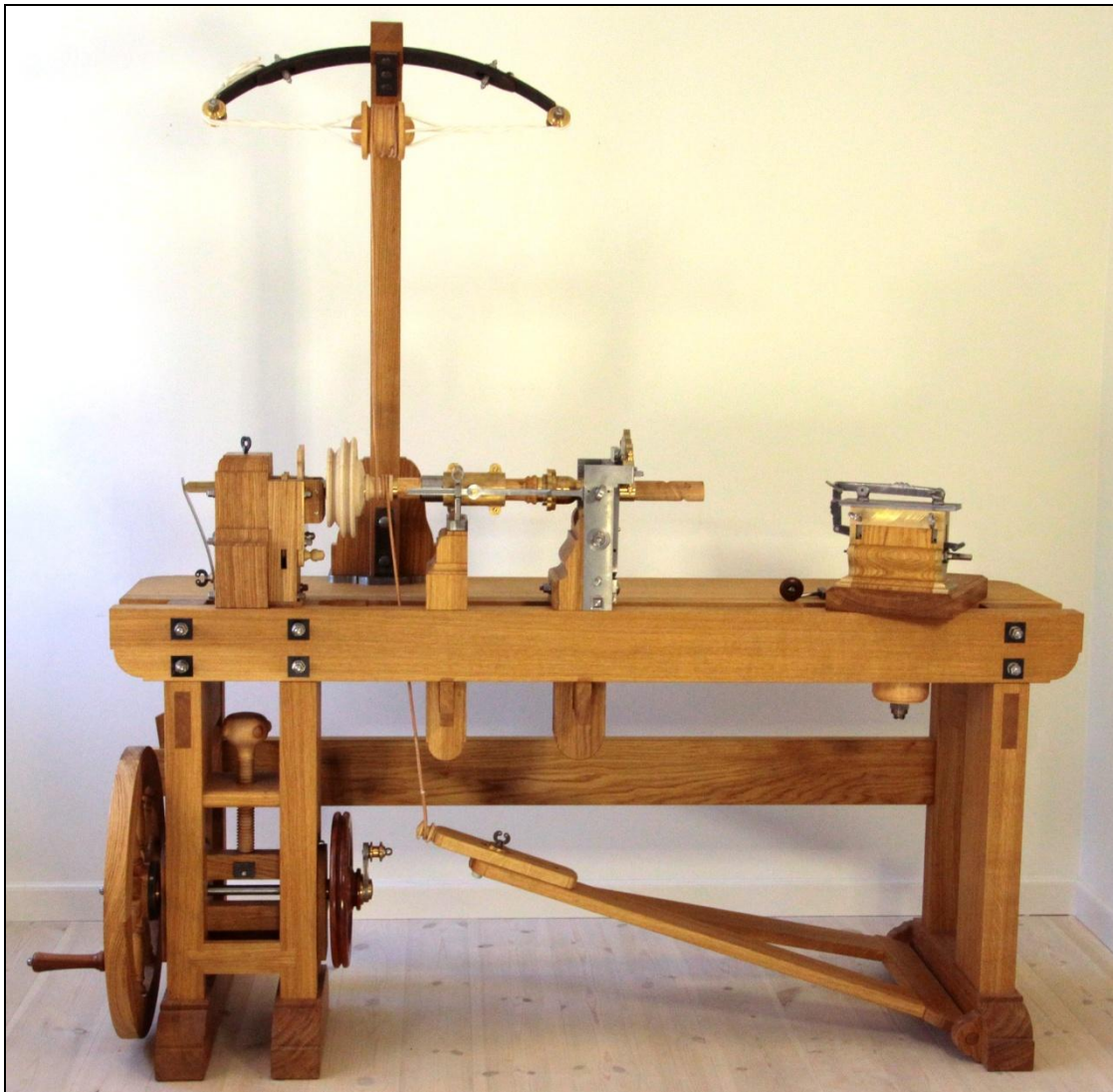
Fig. 80: Rekonstrueret ornamentdrejbænk med opsætning til spiraldrejning (detaljer se fig. 82-90)
