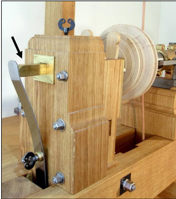
Fig. 92: Bagerste spindeldok med fjedertryk i spindelens længderetning (se pil) Foto: Erckrath
