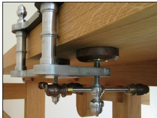
Fig. 52: Flytbar spændanordning til fjederholderen, detalje set nedefra Foto: Erckrath
