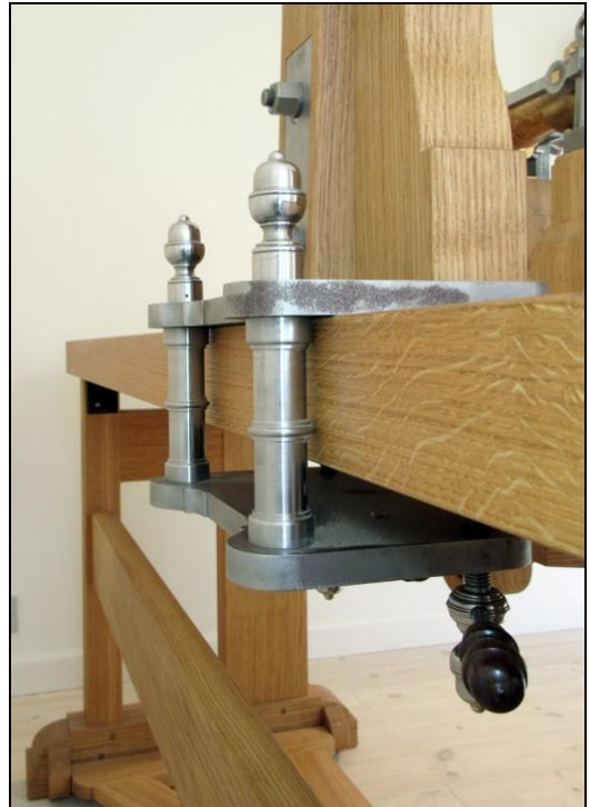
Fig. 51: Flytbar spændanordning til fjederholderen Foto: Erckrath
