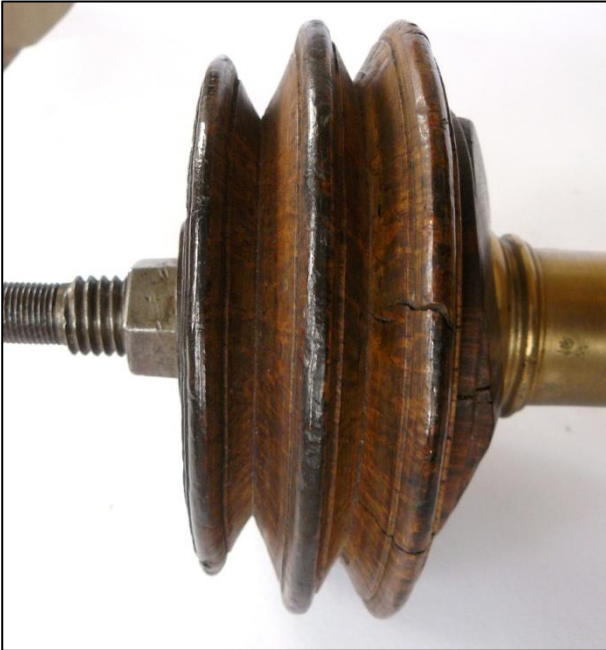
Fig. 37: Remskive (tapskive) nr. 3935 i masurbirk Remskiven er udformet til anvendelse af runde- eller kileformede remme. Masurbirkens tætte og uregelmæssige vækst giver remskiven styrke i alle retninger.
