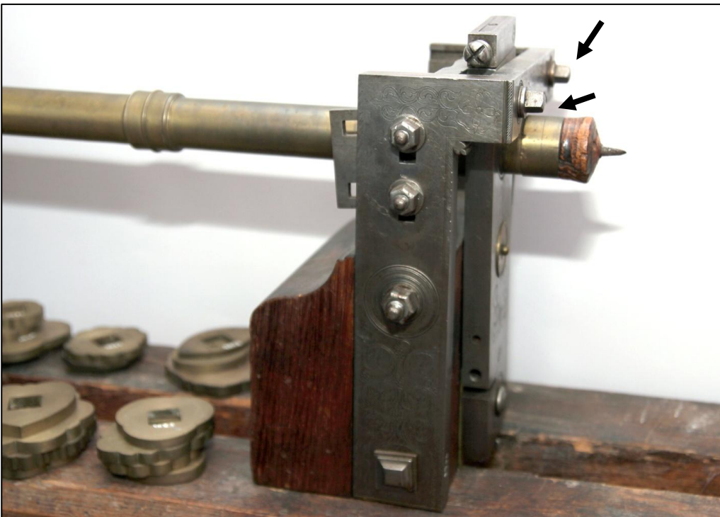
Fig. 11: Spindeldokken nr. 3923 (Carl Gustaf Wrangel) Drejebænken kan anvendes til enkel frihåndsdrejning. Brillen kan ved denne funktion centreres og låses fast med to skruer, som er placeret på fronten af spindeldokken (se pil). Selve spindeldokken og brillen er graveret med rig ornamentik.
