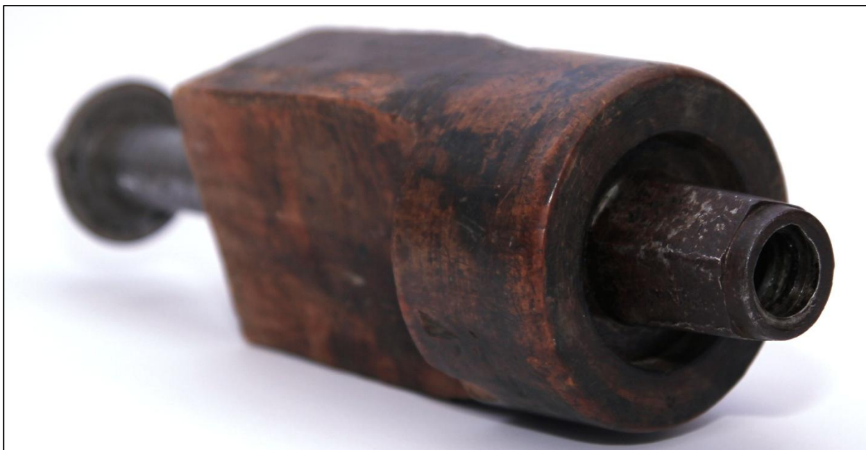
Fig. 106: Spændskrue (anlæg) nr. 7574, med trækloids, møtrik
