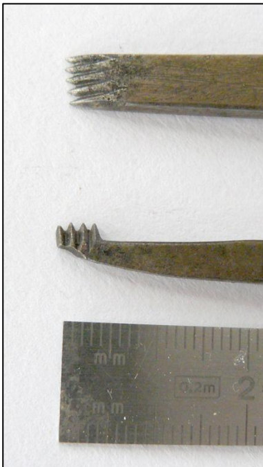
Fig. 155: Drejejern nr. ?, detalje, til skæring af indvendig og udvendig gevind
