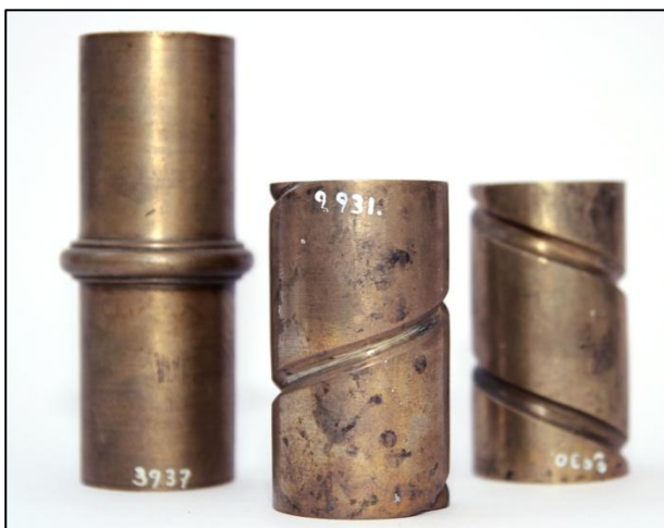
Fig. 66: Spindelementer nr. 3931, nr. 3937, nr. 3930 Løse spindelementer. Spiralelementerne kan ikke tilknyttes en aftaster eller bøsning (contra-del).
