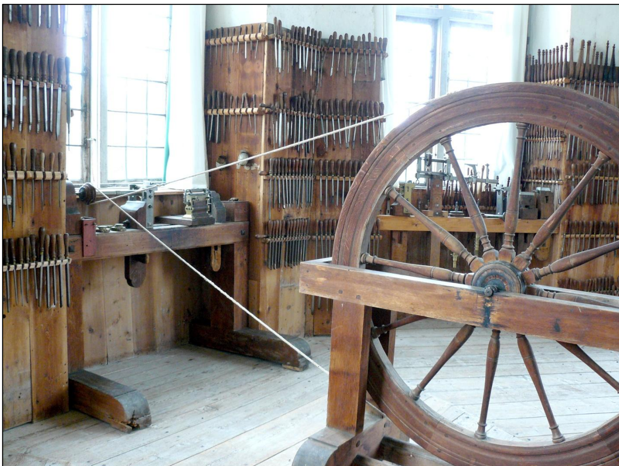
Fig. 3: Drejekammer, Skokloster Slot Drivhjul koblet til den wrangelske drejebænk, som er dateret til 1671–1672. I baggrunden panelerne med de forskellige drejere.
