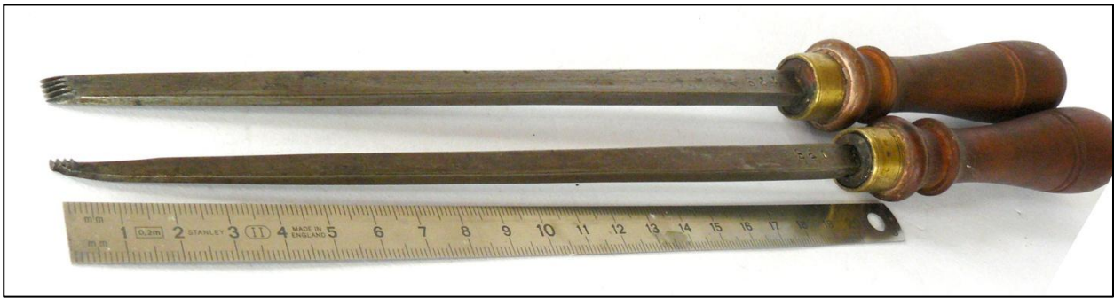
Fig. 153: Drejejern nr. ?, til skæring af indvendig og udvendig gevind
