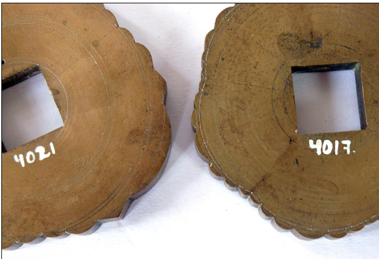
Fig. 86: Metalrosetter nr. 4021, nr. 4017 (detalje), med konstruktionsmarkeringer Messingrosetter viser indridsninger fra ophavsmandens konstruering af mønstret.
