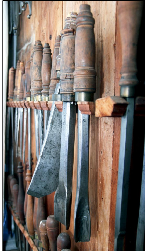
Fig. 151: Drejehjern, (udsnit af vægpanelerne i drejekammeret)
