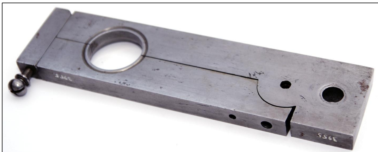
Fig. 132: Spindelbrille (tilbehør) nr. 3055
