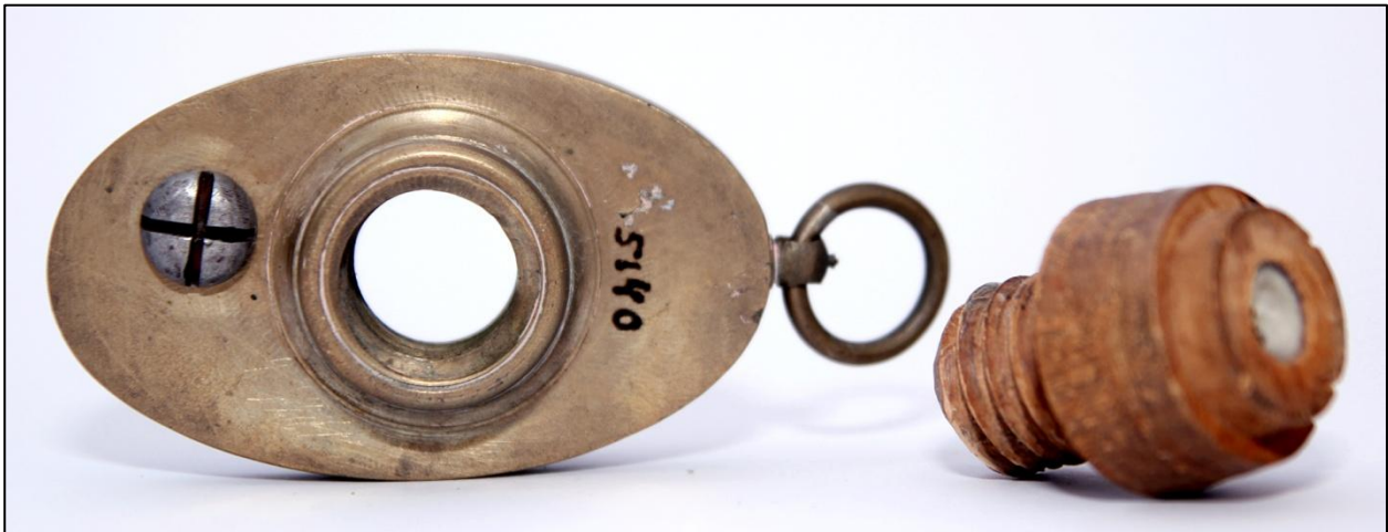
Fig. 124: Gevindskær nr. 5140, træpatron nr. 4098 med samme gevindstørrelse Gevindstørrelse og -stigning af dette gevindskær kan tilskrives Nils Brahes ornamentdejbænk. Gevindet stemmer overens med patronen og passer dermed til spiralens fatning.
