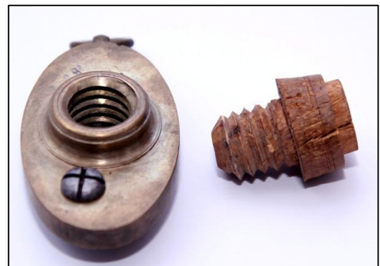
Fig. 127: Gevindskær nr. 5140, træpatron nr. 4098 med samme gevindstørrelse
