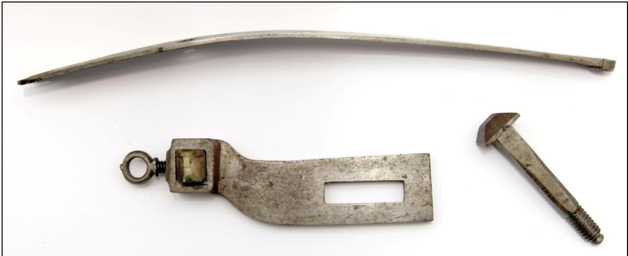
Fig. 137: Diverse tilbehør, holder til benaftaster nr. 3984, fjeder nr. 3987, benaftaster nr. 4130
