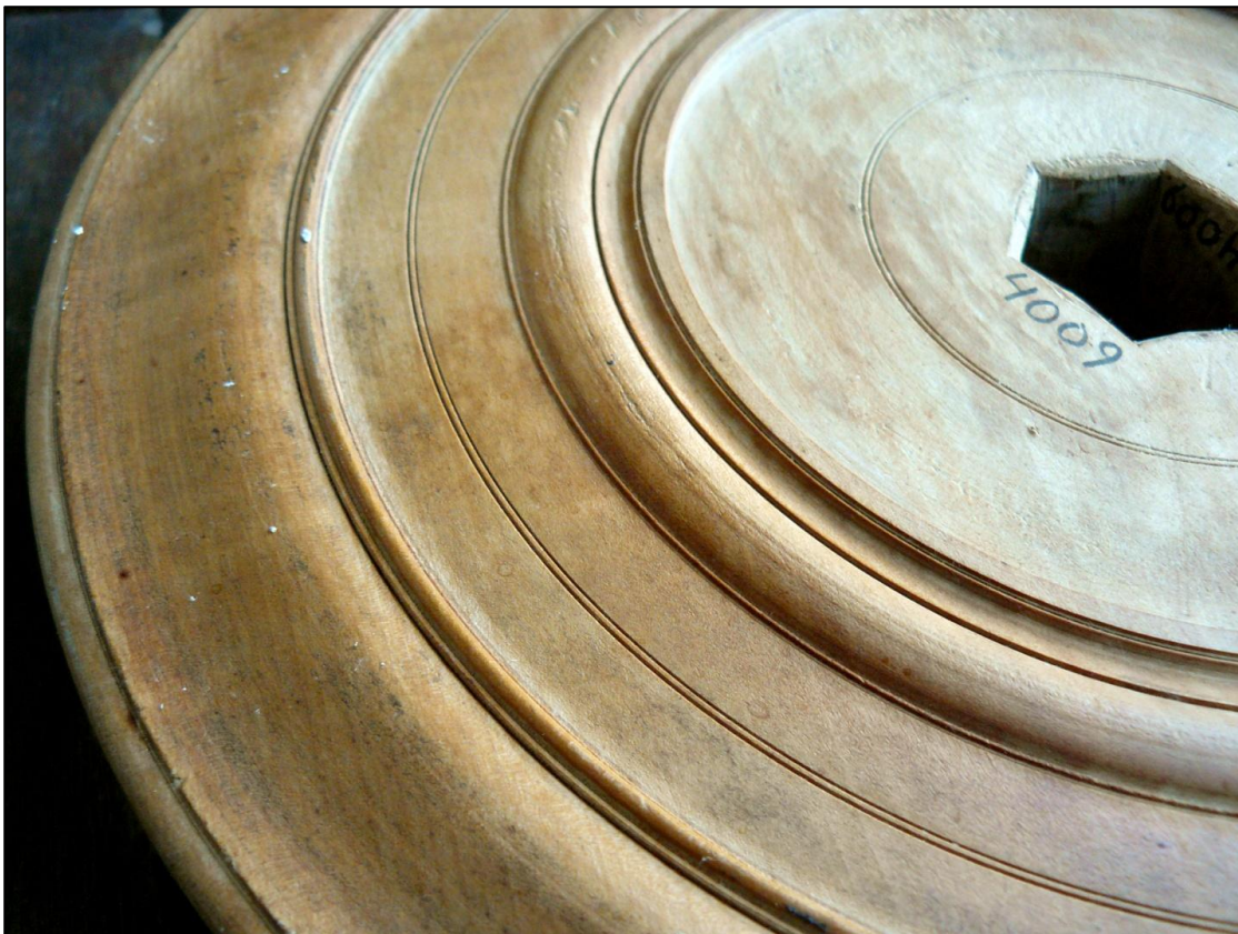
Fig. 142: Remskive nr. 4009, sekskantet midterhul, frugttræ
