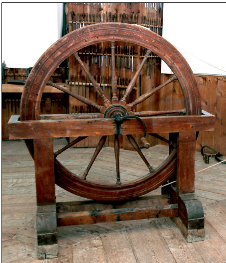
Fig. 4: Drivhjul til at drive drejebænkene
