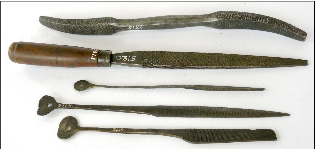
Fig. 158: Rasper (oppefra ned): nr. 5126, nr. 5120, nålefiler: nr. ?, nr. 5114, nr. 5319
