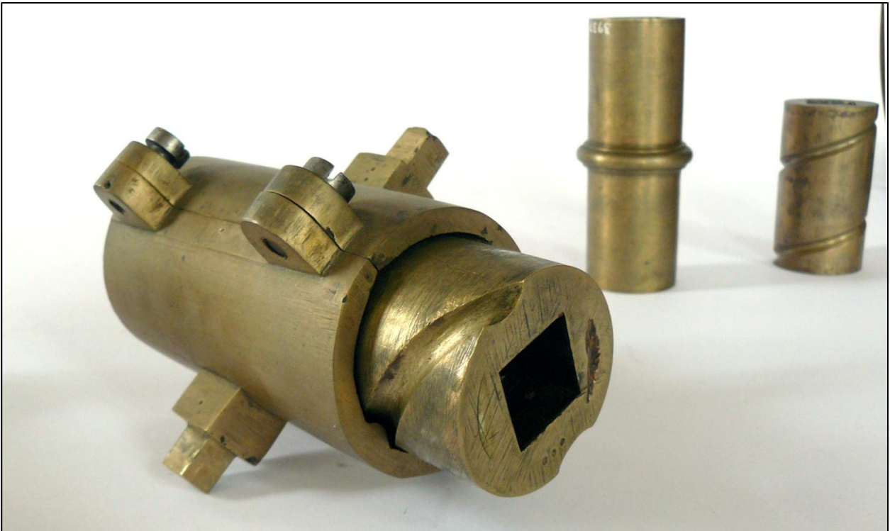
Fig. 29: Spiralelement nr. 3957 (uden aksel)
