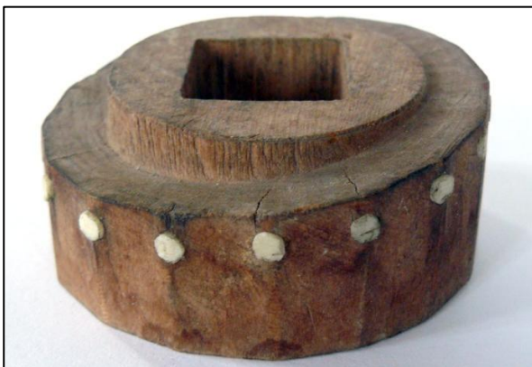
Fig. 78: Træroset nr. 4037, med benindlæg Trærosetten viser en rosetudforming med benindlæg til rosetdrejning samtidig med, at den kan anvendes til passigdrejningen med forskydningsprofilen, som befinder sig på toppen af rosetten.
