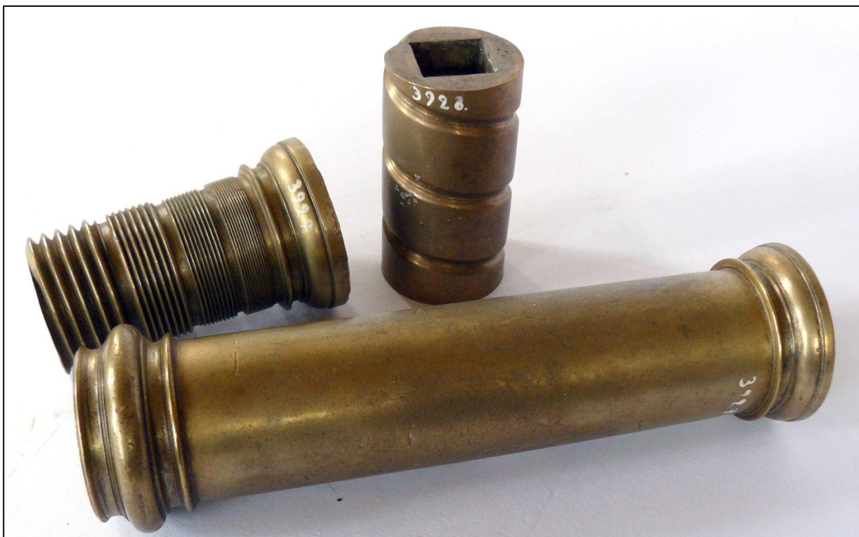
Fig. 65: Spindelementer, nr. 2927 (enkelt), nr. 2928 (spiral), nr. 2929 (gevind)
