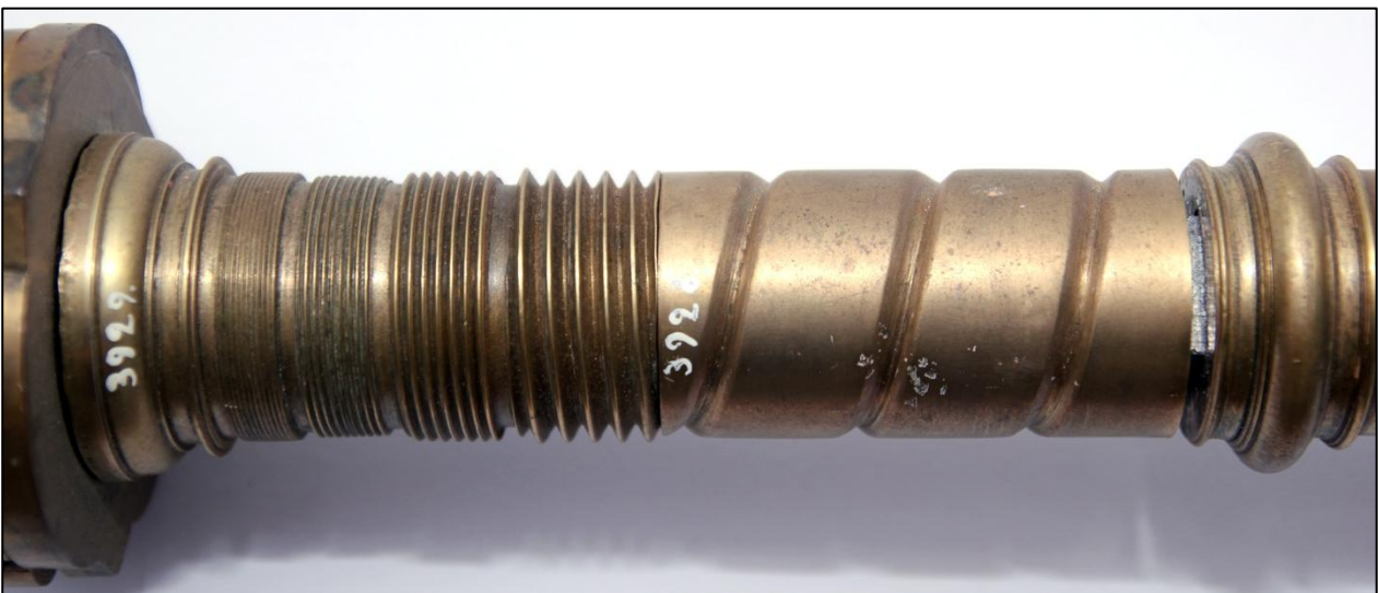
Fig. 64: Spindelement (med fire forskellige gevindstørrelser) nr. 3929, spindelement (spiral) nr. 3928 Der kan ikke tilknyttes nogen form for aftaster til gevindskæringen eller til spiralelementerne (bortset fra spiralanordningen, som indgår i Nils Brahes drejebænk).
