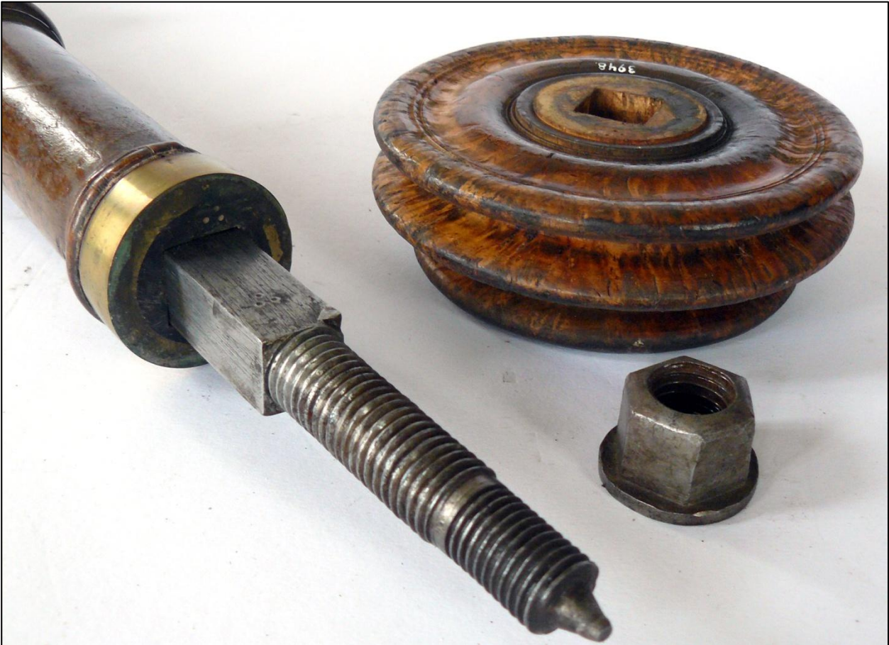
Fig. 59: Aksel med møtrik, remskive nr. 3948
