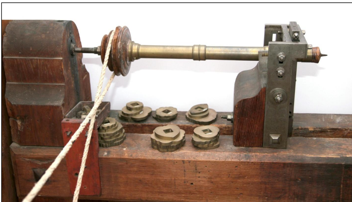
Fig. 8: Rosetdrejebænk af Carl Gustaf Wrangel, bagerste spindeldok, spindeldok
