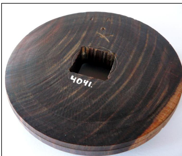
Fig. 71: Roset i pockenholz nr. 4041 Træroset til passigdrejning, tilhører Nils Brahes drejebænk, markeringer som viser placeringen på akslen: "A", "1" og "•" (se pil).
