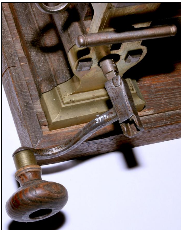
Fig. 99: Anlæg (detalje) nr. 3943, firkantnøgle nr. 3999 til højdejustering
