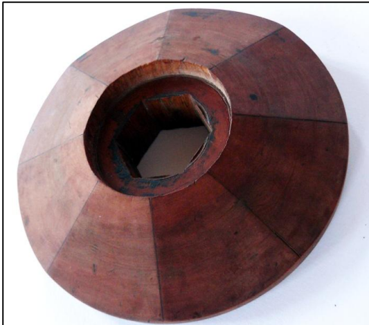
Fig. 76: Træroset i frugttræ nr. ? sekskantet midterhul Denne træroset adskiller sig ved sit sekskantede midterhul.
