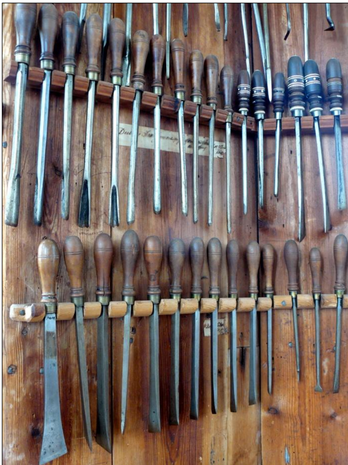
Fig. 149: Drejehjern, (udsnit af vægpanelerne i drejekammeret)
