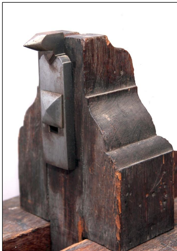
Fig. 49: Pinoldok nr. 3924 Pinoldok med en højdejusterbar pinol.
