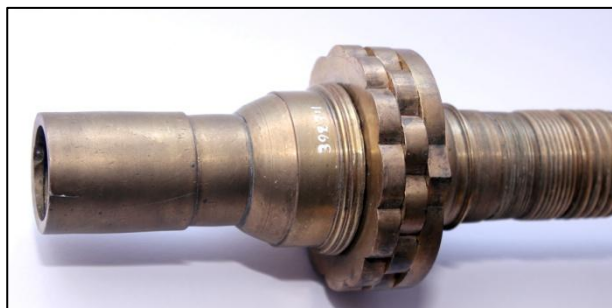
Fig. 56: Spindelhoved nr. 3948 med rosetter og gevindelement
