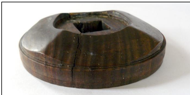
Fig. 32: Træroset nr. 4039, pockenholz Træroset til passigbevægelsens tvangsstyring.
