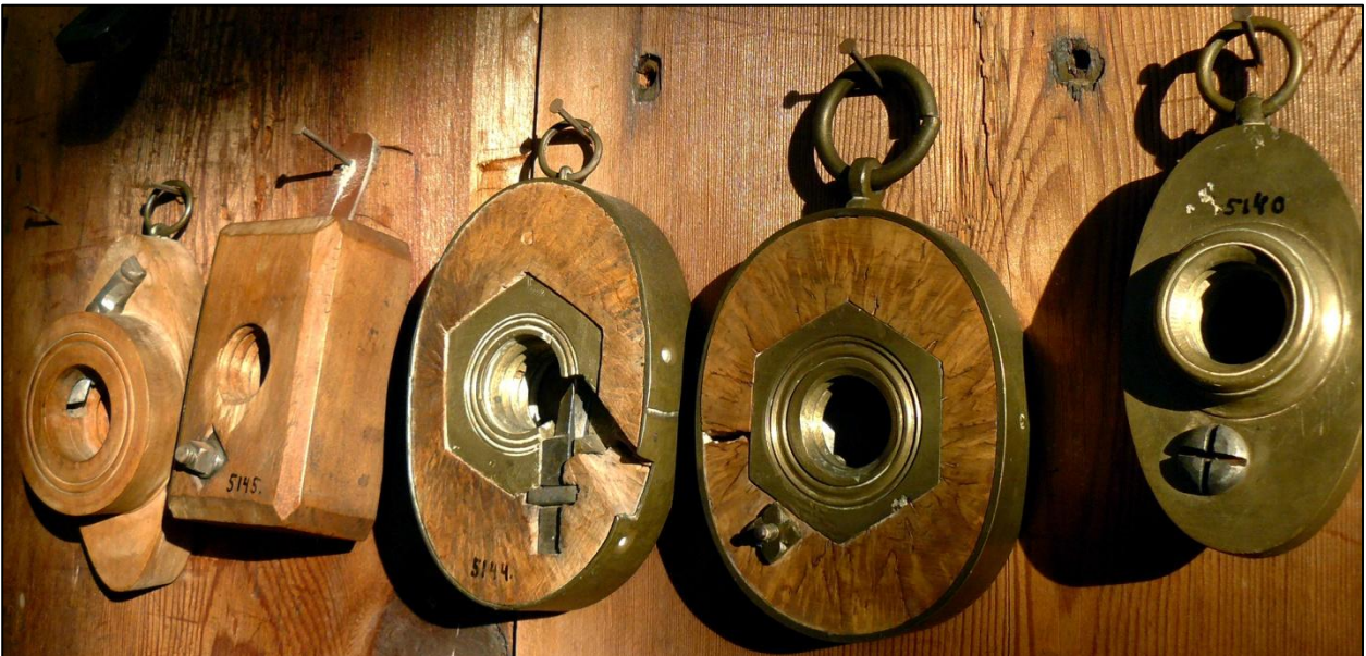
Fig. 123: Gevindskær, forskellige modeller (f.v.), nr. ?, nr. 5145, nr. 5144, nr. ?, nr. 5140 Gevindskæret anvendes til at skære udvendigt gevind på tappe, skruer eller lignende.
