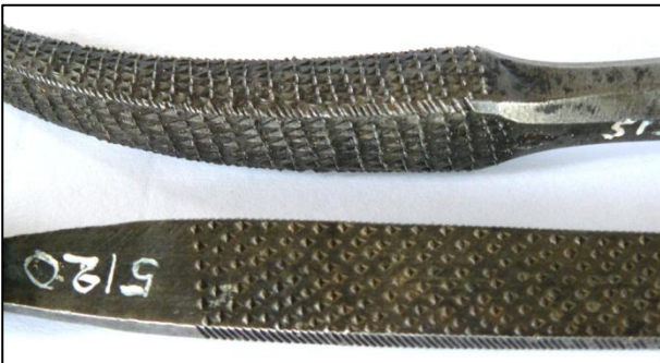
Fig. 159: Rasper (oppefra ned) nr. 5126, nr. 5120, detalje, håndhuggede tænder
