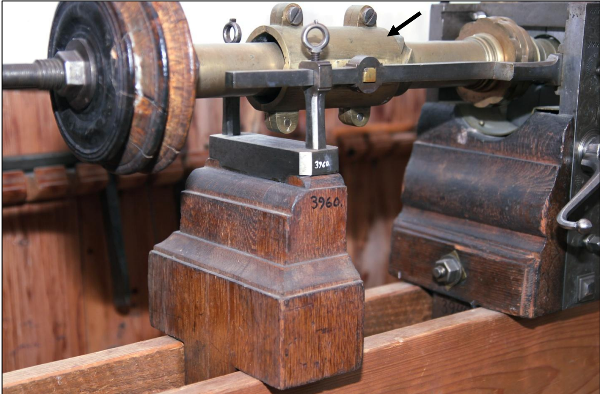
Fig. 20: Spiralspindel, spiralholder nr. 3960, spindeldok nr. 3942 (Nils Brahe) Spiralholderen placerer spindelen i en vandret position. Passigbevægelsen udløses af en bøsning med indvendig spiralvulst (se pil), der under rotationen tvinger spindelen i en sidebevægelse.
