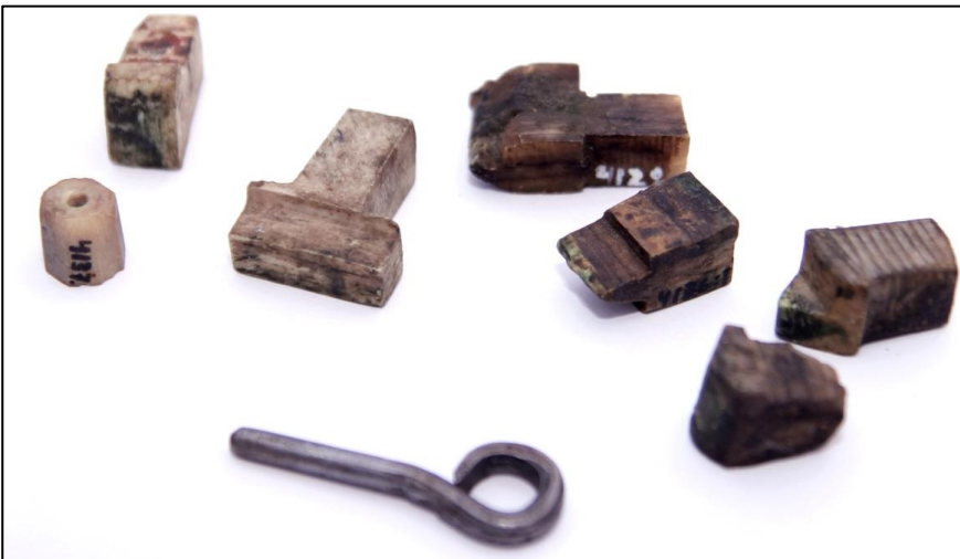
Fig. 144: Tilbehør, bl.a. nr. 4137, nr. 4135, nr. 4129, nr. 4136:1, nr. 4131 Mindre bendele som blev anvendt som aftastere til tvangsstyring. Delene er forskelligt udformet. Et mindre hjul viser ikke den samme grad af slitage.
