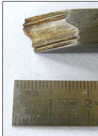
Fig. 156: Drejejern nr. 4462, detalje, til skæring af profil (profiljern)
