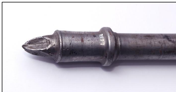
Fig. 58: Spindelhoved nr. 7537, enkel jernmodel (tilhører et andet drejbænkssystem)
