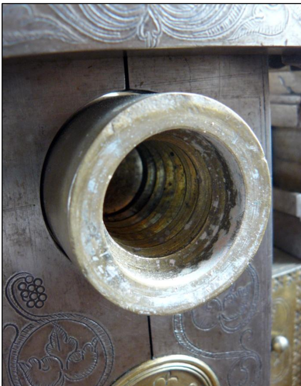
Fig. 36: Spindelhoved nr. 3935 med indvendig gevind (monteret i spindelbrille)
