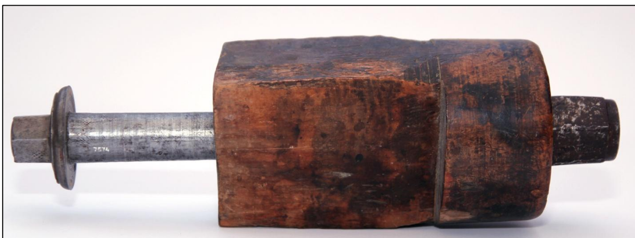
Fig. 107: Spændskrue (anlæg) nr. 7574, med trækloids, møtrik
