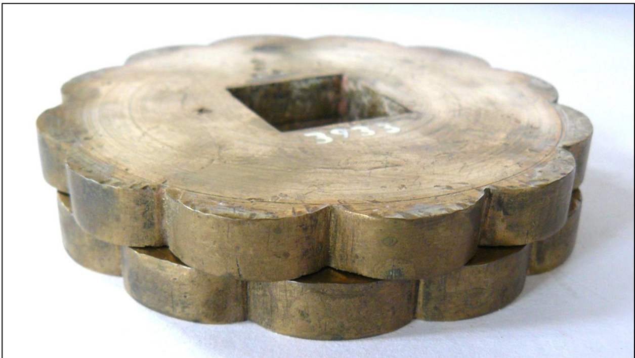
Fig. 88: Metalrosetter nr. 3933/3934; sæt til "pilefletmønster"
