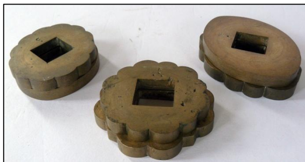
Fig. 90: Metalrosetter, sæt Sæt af messingrosetter til mønsterkombinationer (flere kombinationsmuligheder).
