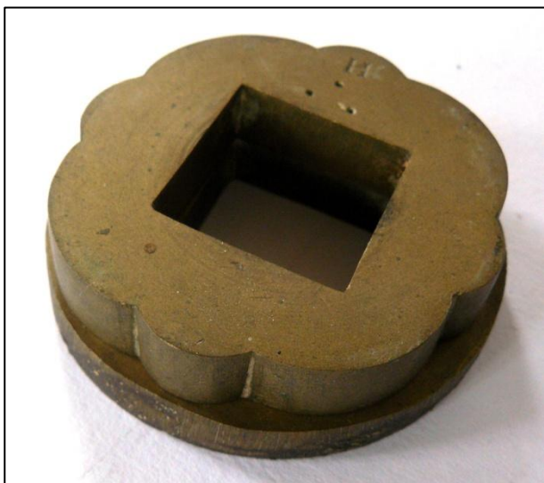
Fig. 89: Metalrosetter nr.4033/4029; sæt Sæt af messingrosetter til superellipseformede mønsterkombinationer.
