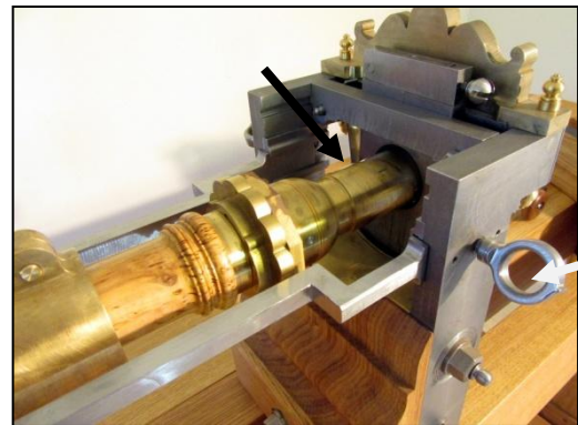
Fig. 155: Spindelen, udstyret med en lang "hals", i dette interval kan spindelen forskydes i længderetning (se pil) Foto: Erckrath
