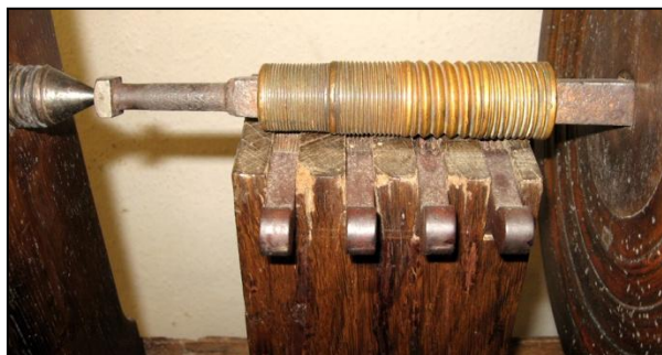
Fig. 128: Anordning til gevindskæring med fire gevindstørrelser, R. Pickaring-drejebænk midten af 1600-tallet (Soulsby, 2012)
