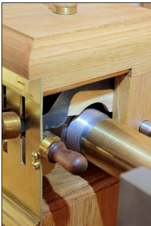
Fig. 162: Gevindboks med løftet aftaster og fritgående spindel Foto: Erckrath
