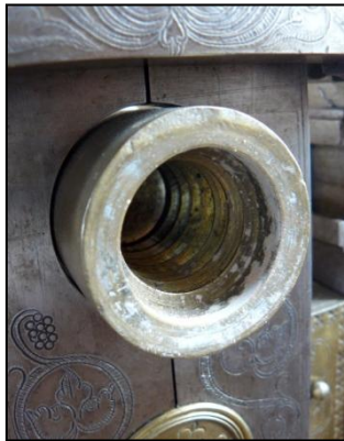
Fig. 87: Spindelhoved nr. 3935, fatning med indvendig gevind, Skokloster Slot Foto: Erckrath
