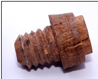
Fig. 88: Træpatron til fiksering af drejemmet på spindelhoved, Skokloster Slot Foto: Erckrath
