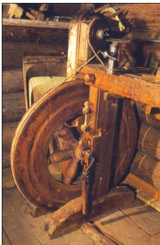
Fig. 74: Solidt udformet drejbænk bygget før 1850, med kontinuerligt omløb, Maihaugen (Buggeland, 2000)
