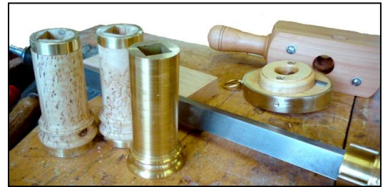
Fig. 143: Spindelementer, aksel og forskellige gevindskær som er fremstillet til projektet Foto: Erckrath
