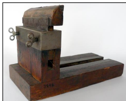
Fig. 82: Anlæg nr.3946 til frihåndsdrejning, højdejusterbar med en kileanordning og spændskruer, Skokloster Slot Foto: Erckrath
