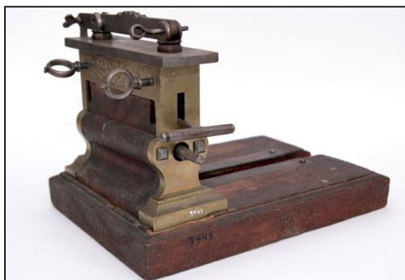
Fig. 83: Anlæg til fiksering af drejejern, inventarnr.: 3943, Skokloster Slot Foto: Erckrath
