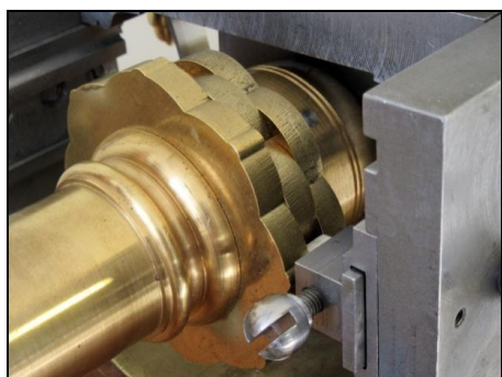
Fig. 148: Rosetterne som anvendes til rosetdrejningen monteret på spindelen Foto: Erckrath
