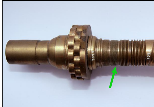
Fig. 122: Separat spindel, spindelement med forskellige gevindstørrelser (se pile), Skokloster Slot Foto: Erckrath
