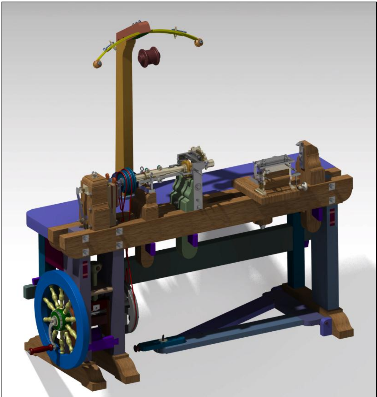
Fig. 141: Rekonstrueret drejebænk, 3D-model udført i CATIA
