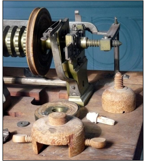
Fig. 64: Drejbænkens bagerste spindeldok, forskellige træpatroner og manuel gevindskær Foto: Erckrath
