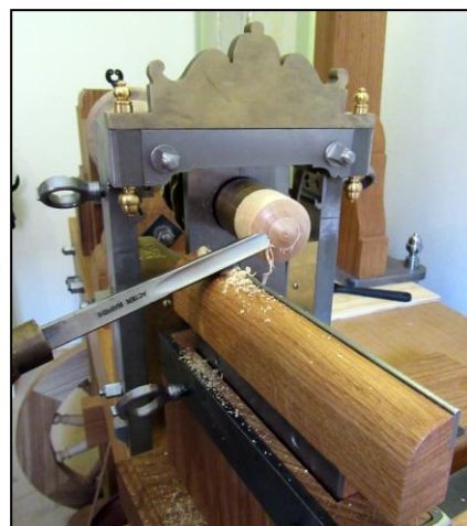
Fig. 146: Frihåndsdrejning med "frit opsat" drejeemnet
