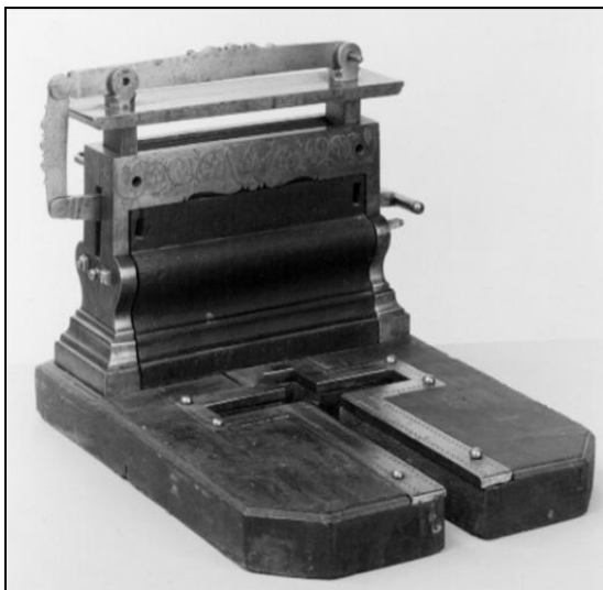
Fig. 58: Anlæg, fremstillet af Johan Kesemacher, tilhører Berghammar Slots ornamentdrejbænk (Samling Livrustkammaren, 2015)
