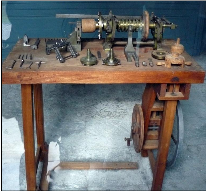
Fig. 63: Ornamentdrejbænk Kina Slot fra midten af 1700-tallet Foto: Erckrath
