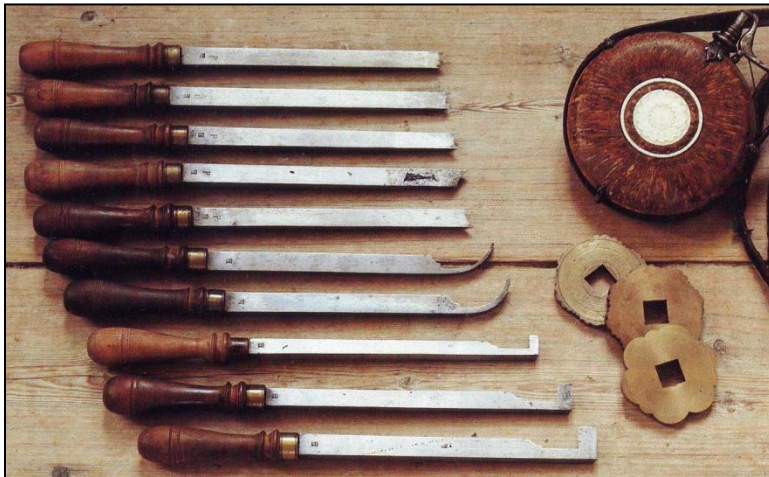
Fig. 132: Drejehjern med forskellige udformninger, Skokloster Slot (Kylsberg, 1985)
