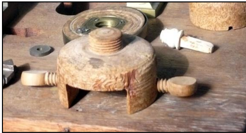
Fig. 90: Træpatron med spændskruer i træ, gevindskær i baggrund, Kina Slot Foto: Erckrath
