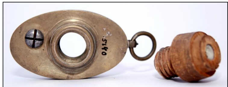
Fig. 135: Gevindskær nr. 5140, træpatron nr. 4098 med samme gevindstørrelse, Skokloster Slot Foto: Erckrath
