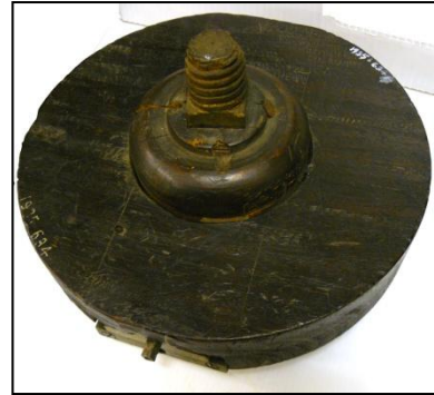
Fig. 95: Chuck, bagsiden: tap med trægevind, fra "rose engine lathe" Blythe House Foto: Erckrath
