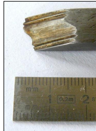
Fig. 133: Drejehjern nr. 4462, detalje, til skæring af profil (profiljern), Skokloster Slot Foto: Erckrath
