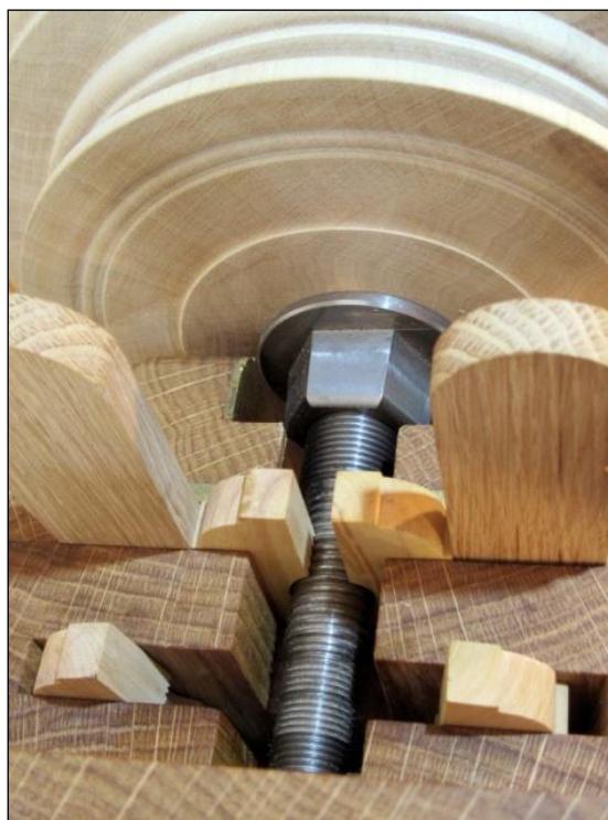
Fig. 163: Gevindskæreteknik med den bagerste spindeldoks saksformede aftaster i buksbom Foto: Erckrath
