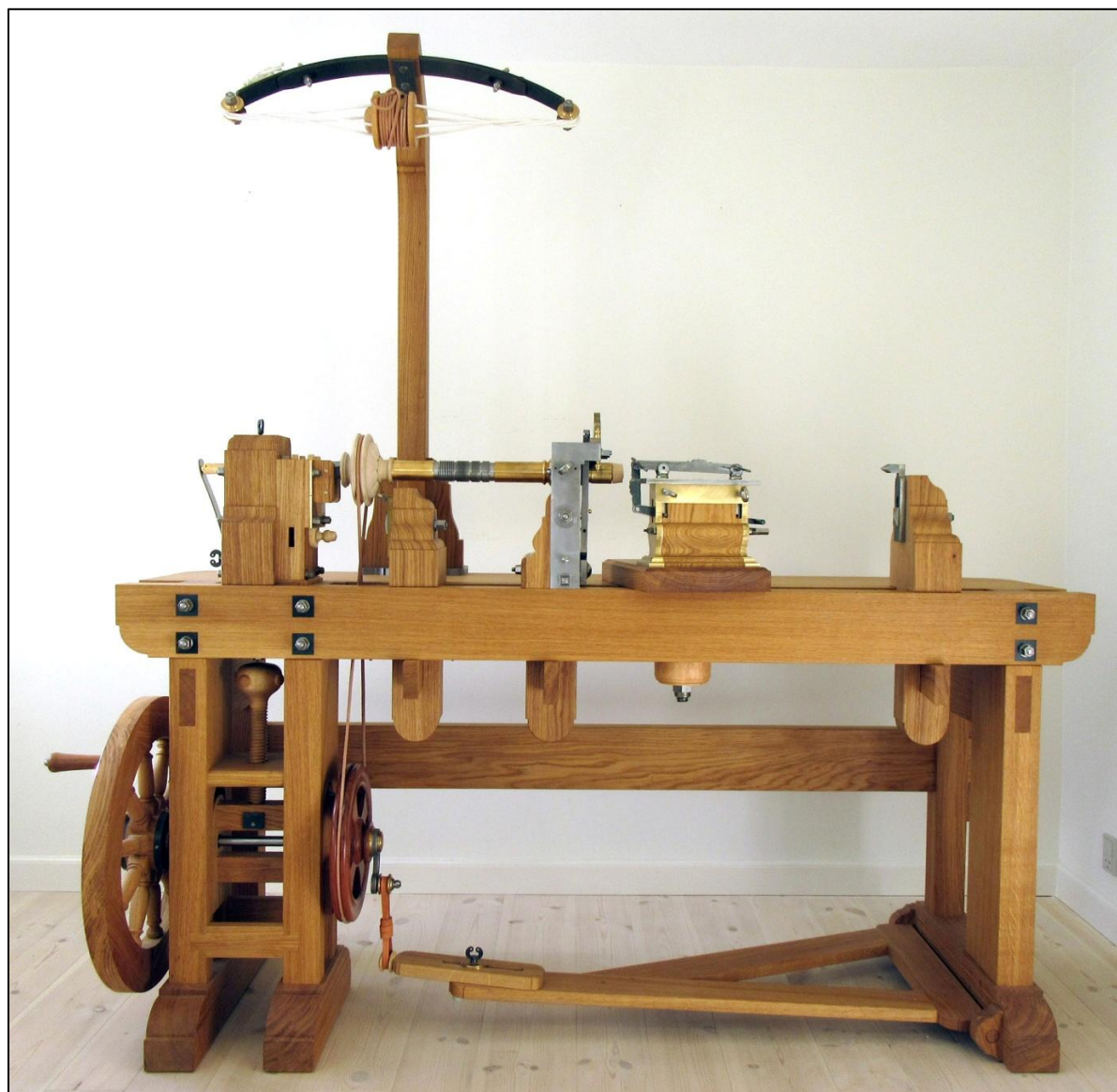
Fig. 136: Rekonstrueret drejebænk, færdiglavet og klart til afprøvning
