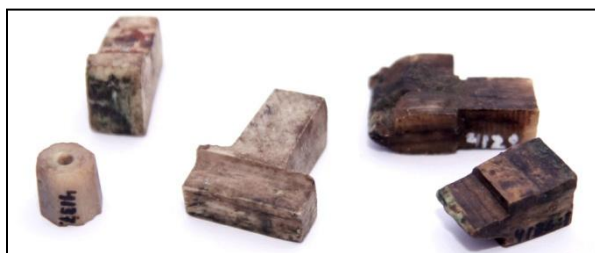
Fig. 98: Forskelligt udformede aftaster til tvangsstyring, Skokloster Slot Foto: Erckrath
