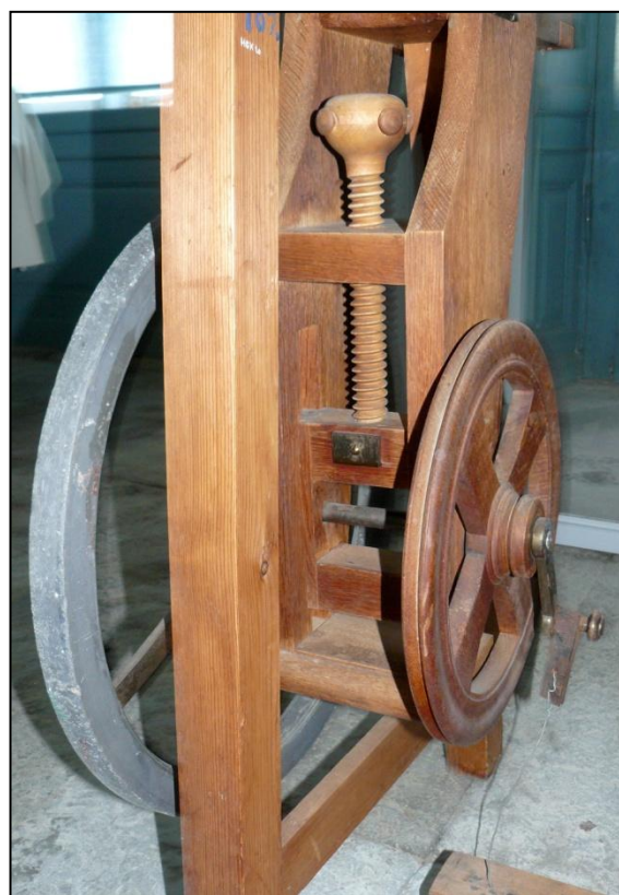
Fig. 75: Drivsystem tilhørende drejbænken på Kina Slot Foto: Erckrath
