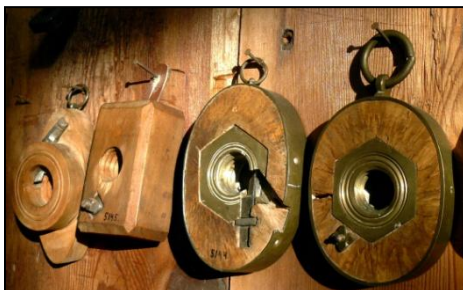
Fig. 134: Gevindskær, forskellige modeller, Skokloster Slots drejekammer Foto: Erckrath
