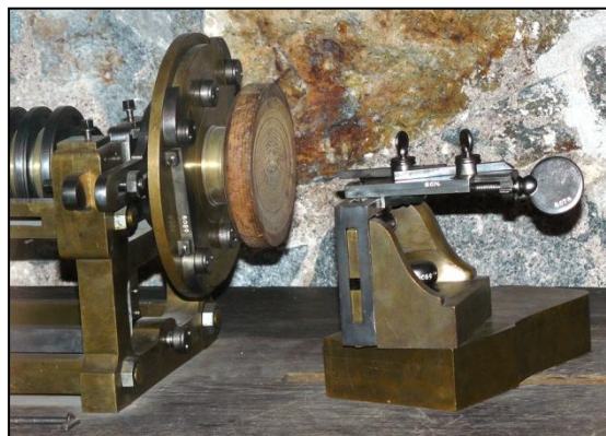
Fig. 67: Ornamentdrejbænk fra Ulriksdal Slot med værktøjssupport og ovalværk Foto: Erckrath
