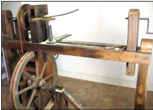
Fig. 37: Ornamentdrejbænk bygget af R. Pickaring, midten af 1600-tallet, England (Soulsby, 2012)
