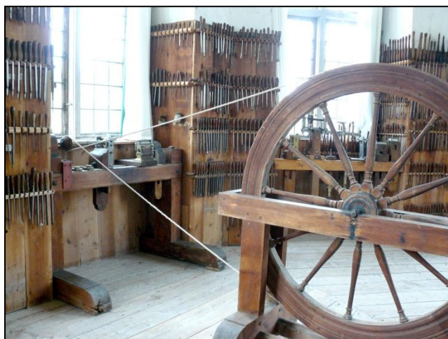
Fig. 53: Carl Gustaf Wrangels drejbænk med drivhjul, i baggrund panelerne med forskellige drejere Foto: Erckrath
