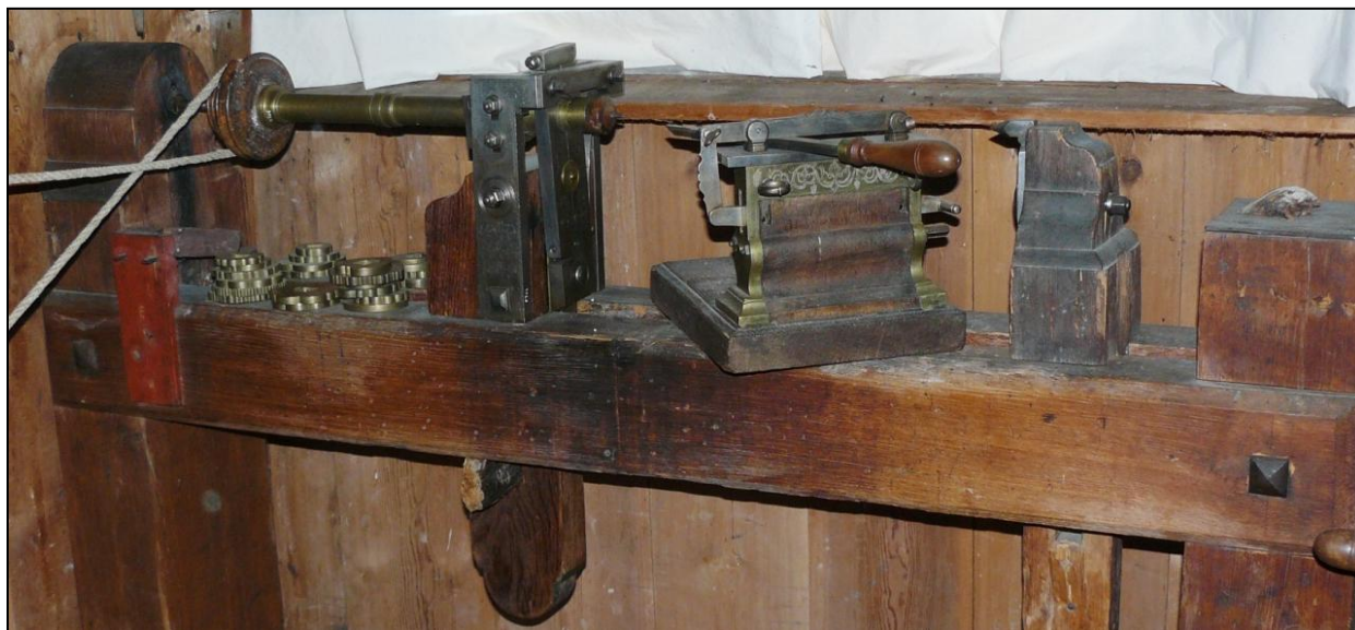
Fig. 54: Carl Gustaf Wrangels drejbænk fra 1671-1672 med stativ og tilkoblet drivrem, opstilling i drejekamret Foto: Erckrath
