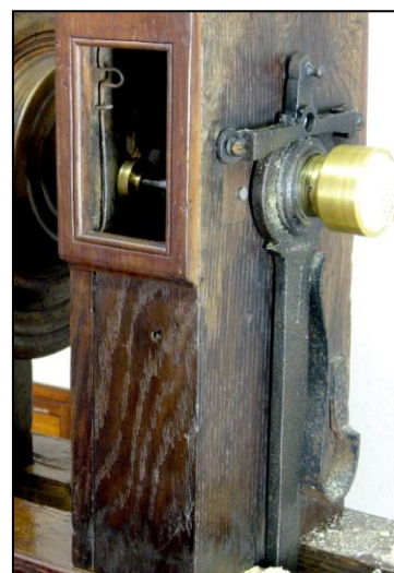
Fig. 40: Spindeldok med sekundær fjeder (Soulsby, 2012)
