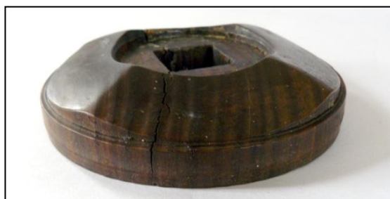
Fig. 115: Træroset til passigbevægelsens tvangsstyring udført i pockenholz, Skokloster Slot Foto: Erckrath
