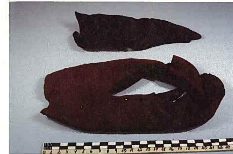
Fig. 3 To lædergenstande efter konservering. Den øverste (sorte) er ikke behandlet med Na<sub>2</sub>EDTA, den nederste (lyse) er behandlet med 0,1 M Na<sub>2</sub>EDTA. Foto: Knud Botfeldt
