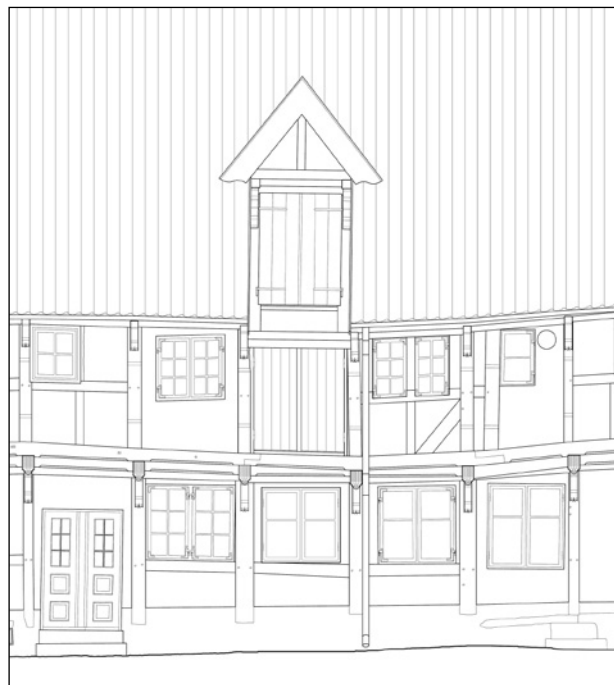
Fig. 3. Opmålingstegninger tegnes i AutoCad – som regel efter hjemkomsten fra feltarbejdet. Principielt kan indtegningen ske direkte på stedet hvis forholdene og kompetencerne tillader det. Tegninger i AutoCad skal følge og matche de principper, høje standarder og niveau for arkitektonisk tegning, der kendes fra den traditionelle opmålingstegning – f.eks. tidligere tiders tuschtegninger. Tegningseksempel fra Perlegade 51 i Sønderborg, udsnit af sydfacade. Opmålt traditionelt og tegnet i AutoCad af Birgitte Tanderup Eybye 2007.
