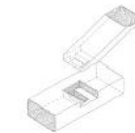
Spærfødder med kio og hæl.
