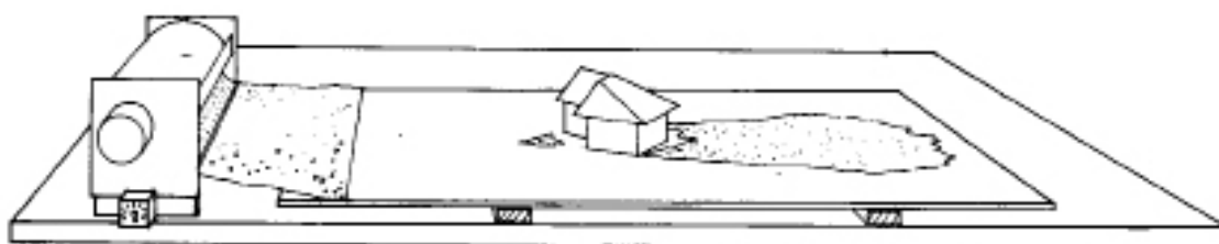
Anne Brit Børves skitse til opstilling af vindbord med tværstrømsventilator. Kilde: AHO skrift IV
