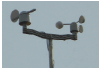
Kopanemometer til måling og registrering af vindretning og hastighed.
