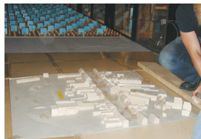
Opstilling til modelforsøg i vindtunnel hos Force Technology i Lyngby.
