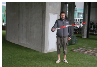
Registrering af lokalt vindmiljø med plastikstrimmel som indikator for vindretning og hastighed.
