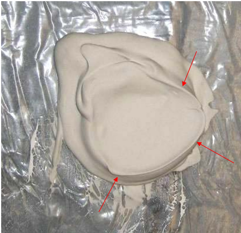
Figur 8.1.3 // Dette stadie afspejler det bedste stadie i krystalliseringsprocessen til at fastholde et øjeblik af en væske i hurtig bevægelse. Gipsleret har opnået en styrke, men lader sig samtidig forme, hvilket kan ses på de skarpe kanter, der er udpeget med røde pile.
