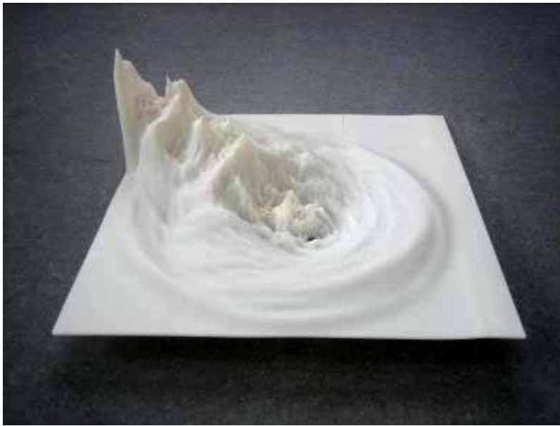
Figur 9.1.3 // 3d print ved hjælp af en 3d printer fra Dimension af den digitale formgivning på figur 6.2.6, sektion 6.2.
