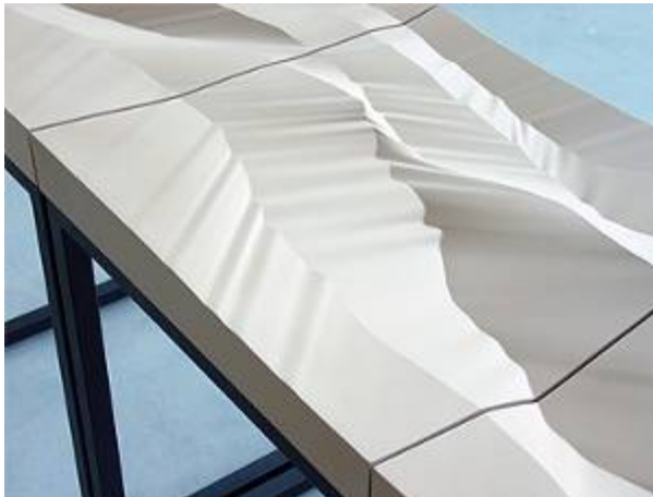
Figur 5.2.12 // Detalje af CNC fræsningen på figur 5.2.11. Foto: Tavs Jørgensen.
