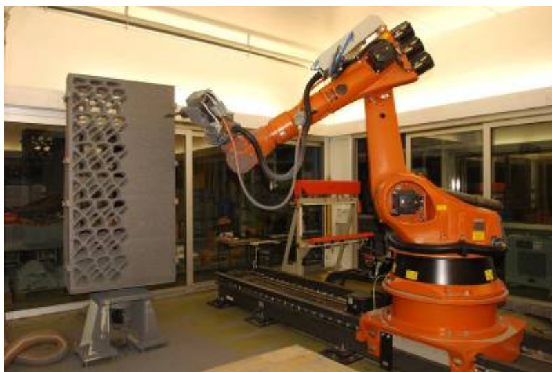
Figur 9.1.6 // En digitalt styret robot arm med et omskifteligt "hoved" på ETH. © Gramazio & Kohler, ETH Zurich.
