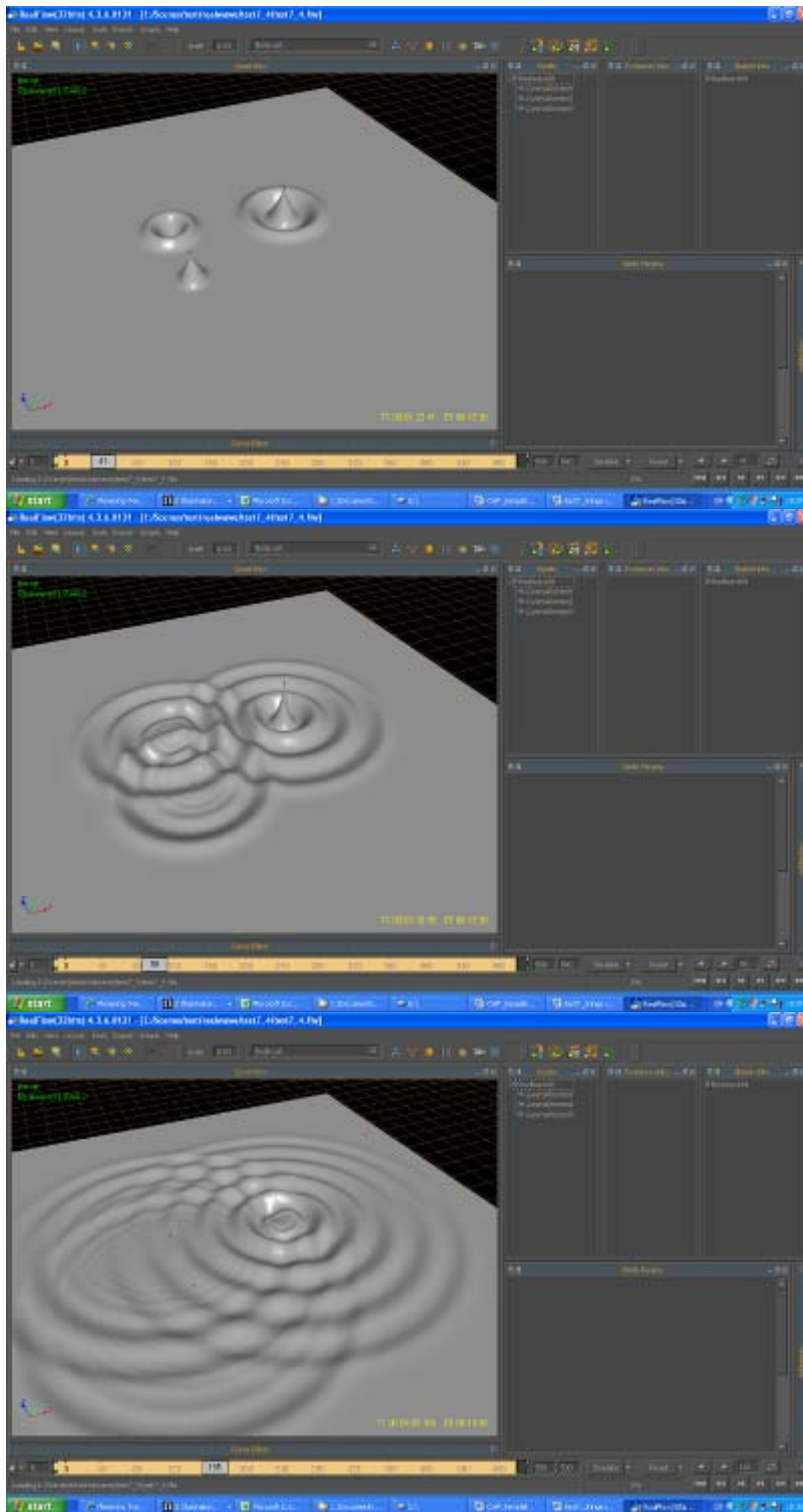
Figur 6.2.4 // Tre stadier af en flade, der genererer bølger fra tre punkter. Punkterne bevæger sig forskudt over tid lineært op og ned og genererer interferens. Se endvidere animationen i appendikset, se figurens nummer.
