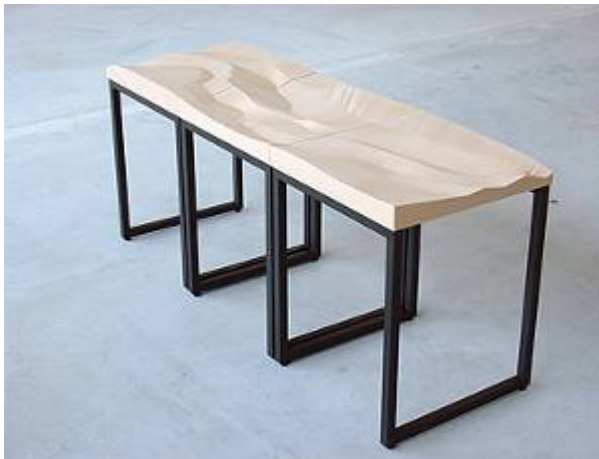
Figur 5.2.11 // Den digitale formgivning er blevet overført til fysisk form ved hjælp af CNC fræsning. Foto: Tavs Jørgensen.
