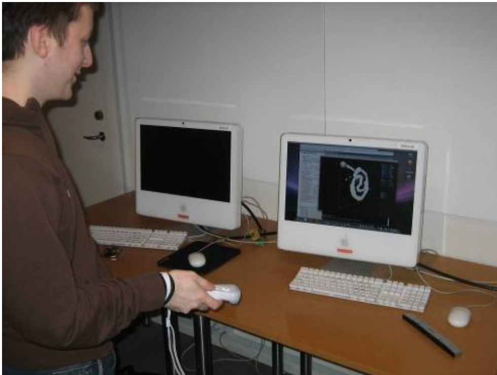
Figur 7.4.3 // En wii-mote indfanger formgiverens 3d bevægelser med hånden.
