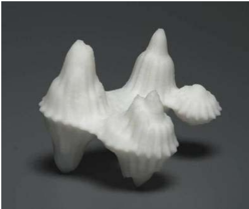
Figur 7.2.4 // Geometrien på figur 7.2.3a kan efterfølgende 3d printes ved hjælp af Rapid Prototyping.
