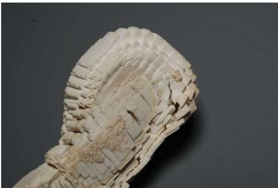
Figur 9.2.12 // Forskellighed i udsmeltning og tendens til at falde sammen og revne.
