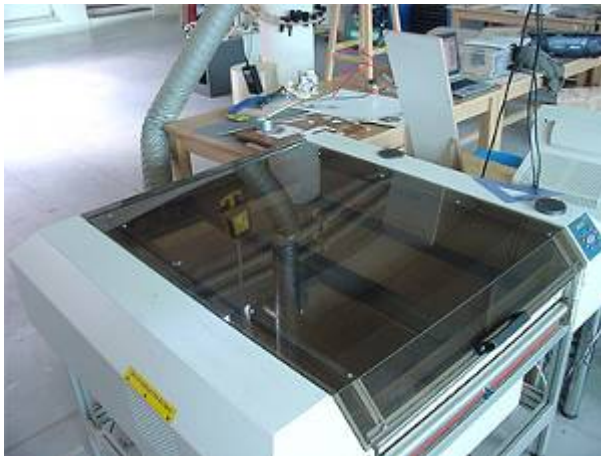
Figur 4.3.4 // Redskabet bliver overført til fysisk form ved hjælp af en laser skærer. Foto: Tavs Jørgensen.
