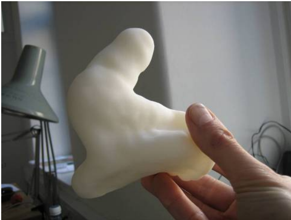
Figur 6.1.12 // Billede 95 fra figur 6.1.11 er her overført til fysisk form ved hjælp af en 3d printer fra Dimension. Denne teknik overfører den 3d digitale form ved at bygge den op i 0,254 mm tynde lag i ABS plastik.
