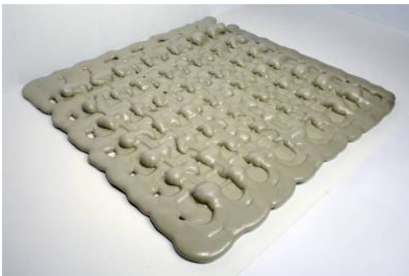
Figur 9.1.8 // Eksperiment med at formgive plade med polyuretan skum ved hjælp af robot armen på figur 9.1.6. Udfordringen har i dette eksperiment handlet om samspillet mellem det fysiske materiales potentiale og det digitale formgivningsredskab. Dette har involveret en analyse af polyuretan skum og dets egenskaber for at forstå materialets muligheder i forbindelse med robot armen, f.eks. ekspanderer polyuretan skum. © Gramazio & Kohler, ETH Zurich. Credits: Intersecting lines create a woven structure, 2007. Students: Kathrin Hasler, Hannes Oswald. Gramazio & Kohler, Architecture and Digital Fabrication, ETH Zurich Collaborators: Silvan Oesterle (project leader), Ralph Bärtschi, Michael Lyrenmann Industry partner: Cellform AG, PU-Technik Meyer
