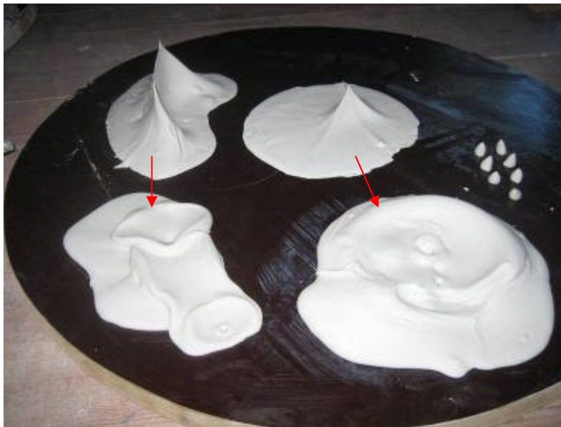
Figur 8.1.6 // Udvalgte resultater fra forsøgsrække B. De røde pile markerer resultaterne som par, der peger fra den hængende gips-ler til den faldne gips-ler.
