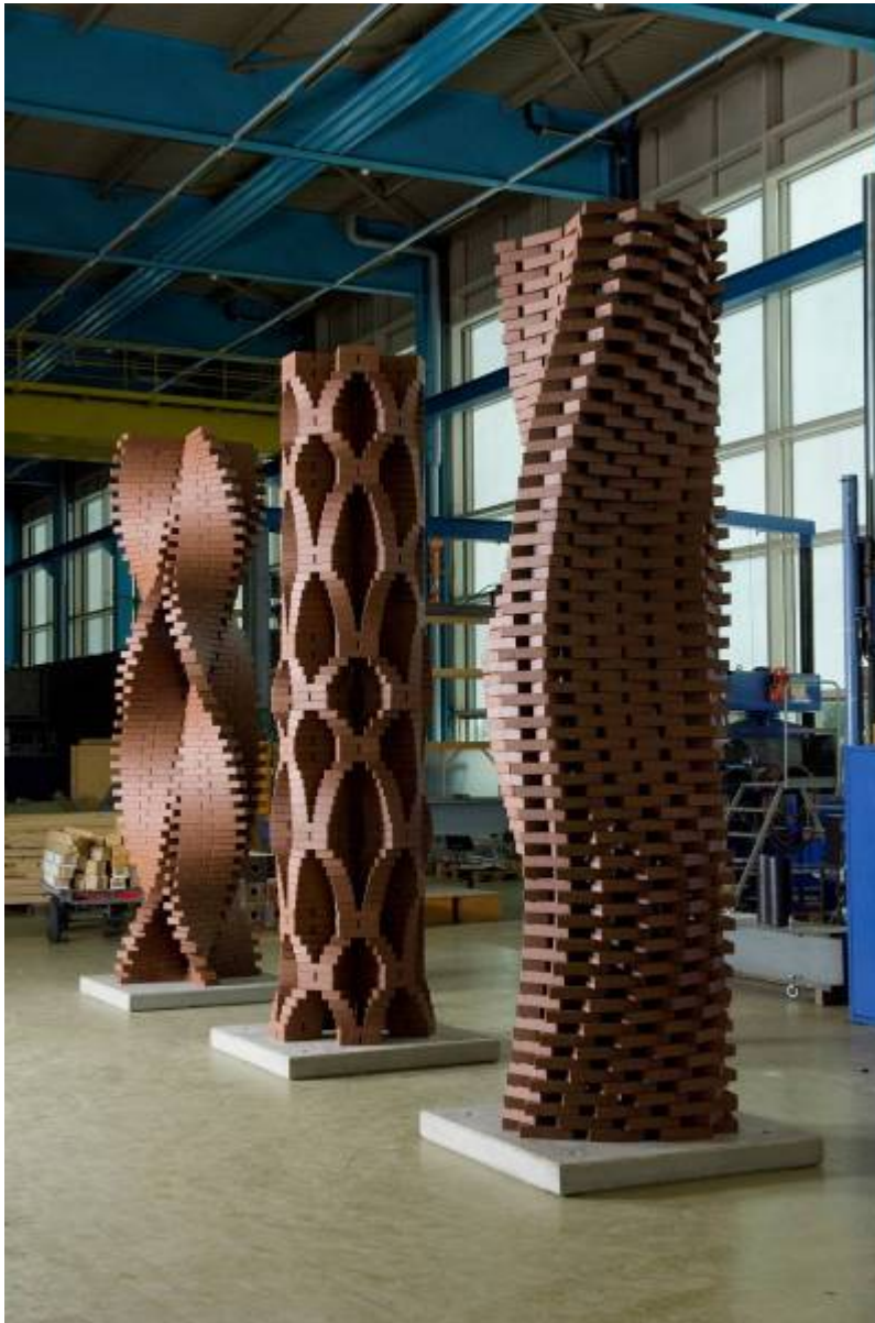
Figur 9.1.9 // Eksperimenter med at bygge med mursten ved hjælp af robot armen på figur 9.1.6. I et 4 ugers forløb skulle de studerende formgive og udføre 3 søjler på 4 meter. Funktionelle kriterier for stabling har været konkret afprøvet som modeller i 1:1 og ved hjælp af digital simulering, hvorefter at søjlerne er blevet formgivet og udført ved hjælp af robot armen. Eksemplet viser at det er muligt at opnå en høj grad af kompleksitet med en høj præcision. The Programmed Column 2, ETH Zurich, 2010.
