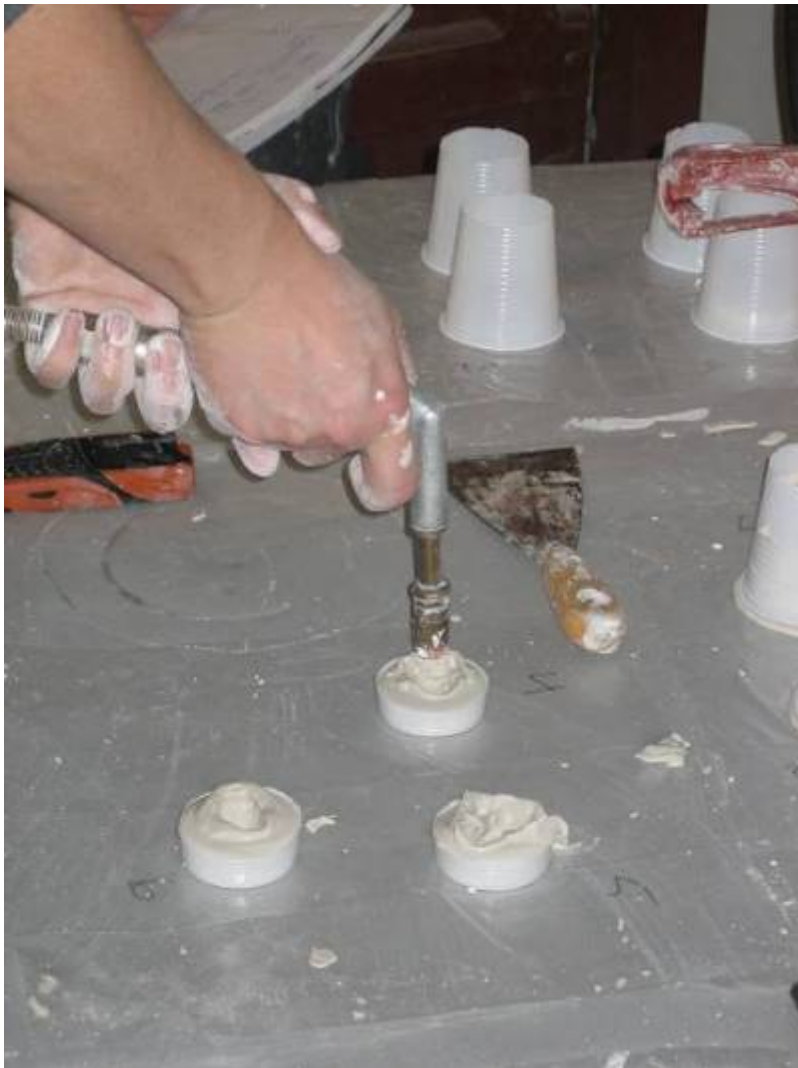
Figur 8.1.9 // Trykluft blæses i 90 grader ned i gips-lerets forskellige stadier i krystalliseringsprocessen.
