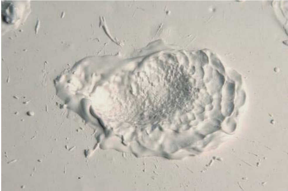
Figur 8.1.10 // Gips-leret påvirket af trykluft i en vinkel på 90 grader. Tryklufften muliggør en stor variation i gips-lerets overflade fra helt små dramatiske og spidse formationer til større og mere bløde formationer.
