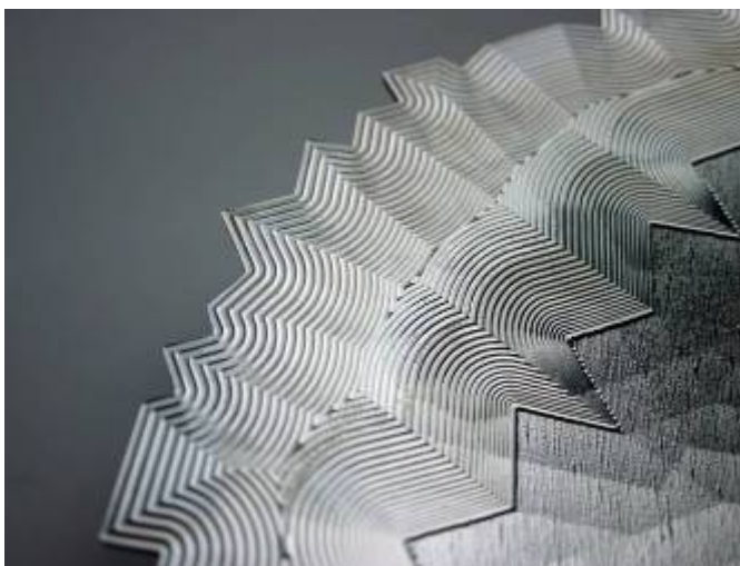
Figur 4.3.14 // Detalje af CNC fræsningens spor på figur 4.3.13. Drummond Masterton 2007. Foto: Drummond Masterton.
