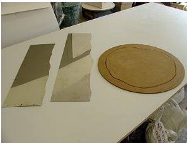
Figur 4.3.5 // Laser skæren har skåret plader af forskellige materialer og tykkelser. Foto: Tavs Jørgensen.
