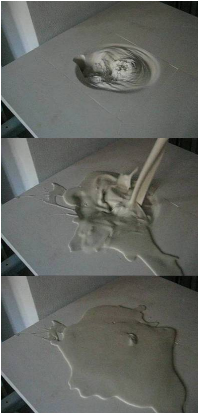
Figur 6.3.3 // Den RP producerede model på figur 6.3.2 har dannet basis for et gipsaftryk. Den flydende porcelænsmasse bliver hældt fra en kande, hvilket har betydning for, hvordan porcelænsmassen plasker og flyder under formgivningsøjeblikket.
