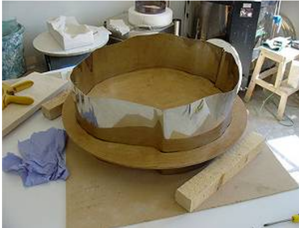
Figur 4.3.6 // Redskabet er samlet og klar som underlag til at smelte glasplader (slumping). Foto: Tavs Jørgensen.
