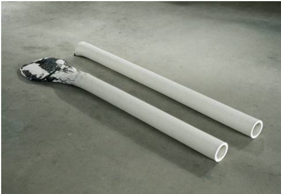
Figur 1.1.8a // Deform 2 . Cylindre af stentøj har fået tilsat forskellige mængder af råmaterialer i leret på specifikke steder i formen, der har nedsat smeltepunktet. Længde 180 cm. Et samarbejde mellem Gitte Jungersen og Flemming Tvede Hansen 1999.
