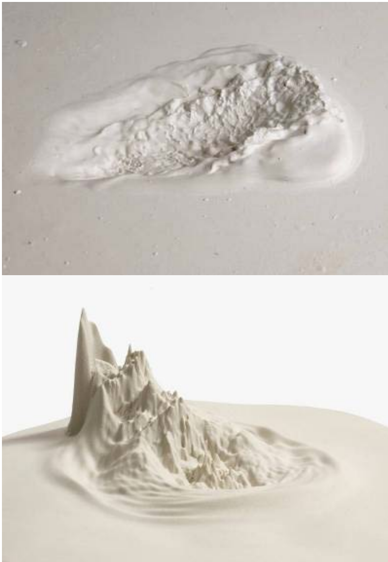
Figur 8.2.1 // En sammenligning mellem resultatet på figur 8.1.10 fra forsøgsrække C med højtryksluft og det område på figur 6.3.4 i sektion 6.3, der afspejler det RP producerede artefakt. Sammenligningen viser et sammenfald.
