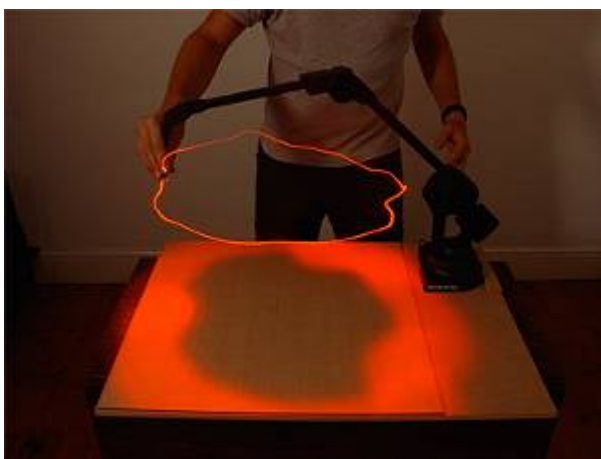
Figur 4.3.2 // Tegning i 3d med en digitizing arm. Den røde kurve bliver ikke tegnet i virkeligheden, men viser et eksempel på den bevægelse, der bliver overført til digitalt data.. Foto: Tavs Jørgensen.
