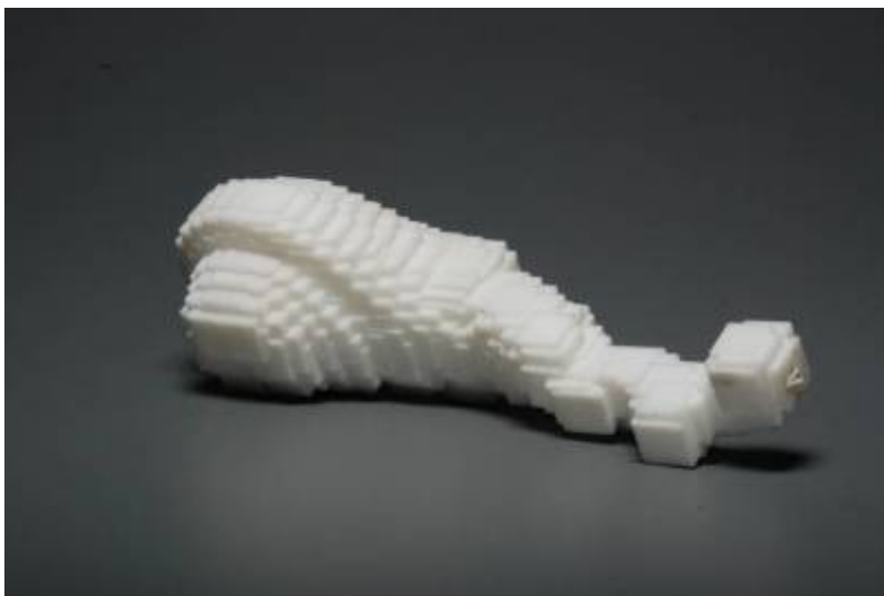
Figur 9.2.2 // Det RP produceret 3d artefakt af den digitale formgivning fra figur 9.2.1
