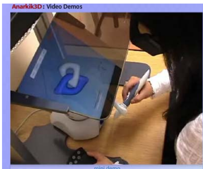
Figur 7.6.1 // Snapshot fra en demonstrationsvideo af et teknisk udstyr, der yder modstand på baggrund af et valgt digitalt materiale i softwaret DrawnRealityPro .
