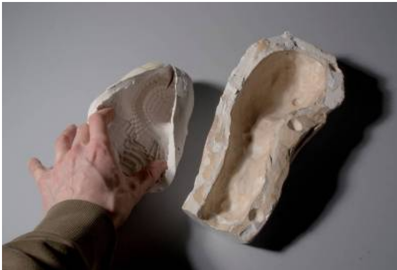
Figur 9.2.3 // Halvdelen af silikoneformen og den forstærkende kappe af gips af det RP produceret 3d artefakt fra figur 9.2.2
